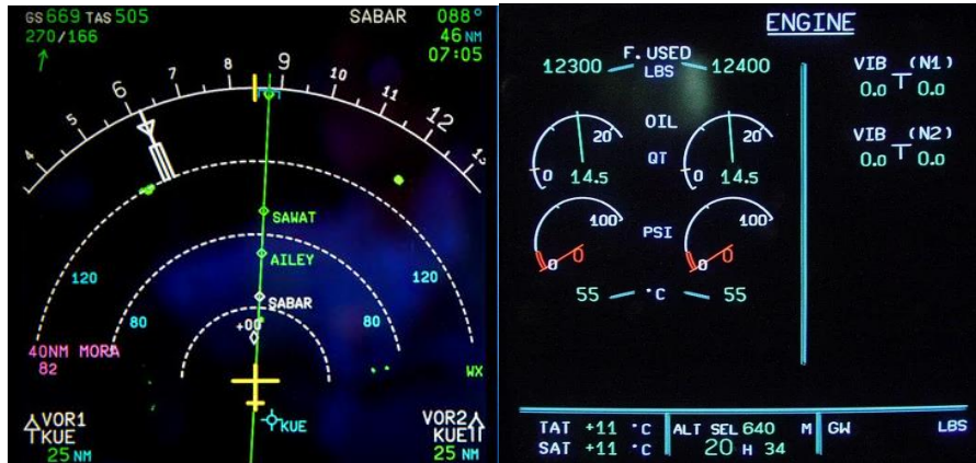
Рисунок 1.5. Индикация навигационного кадра (ND) и кадра отображения параметров двигателя и предупреждающих сообщений (EWD)
