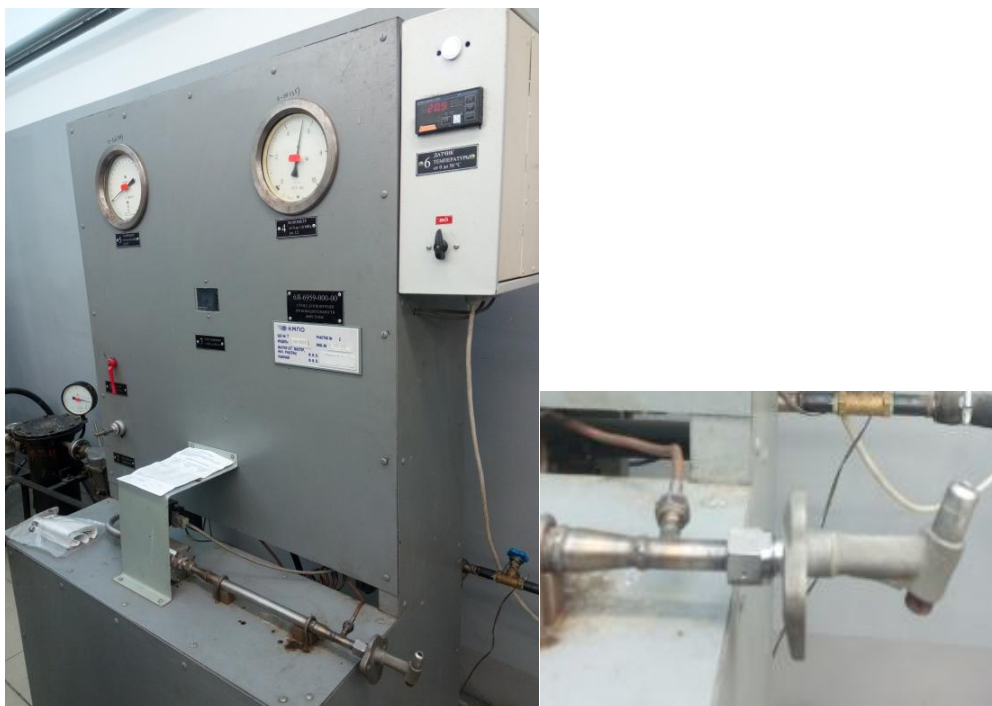
Рис. 5. Фото стенда испытаний форсунок
