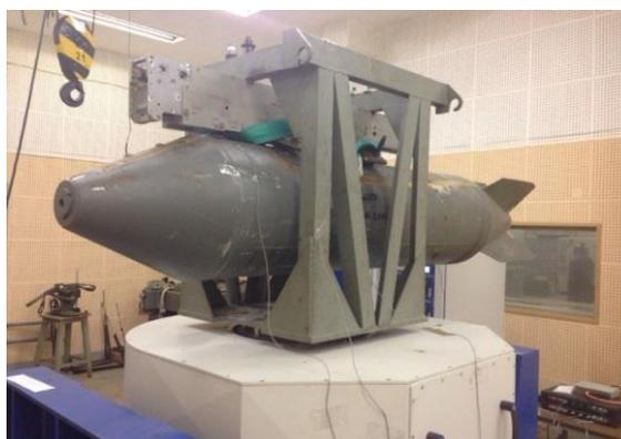
Рис. 2. Приспособление для вибрационных испытаний с закрепленным изделием
