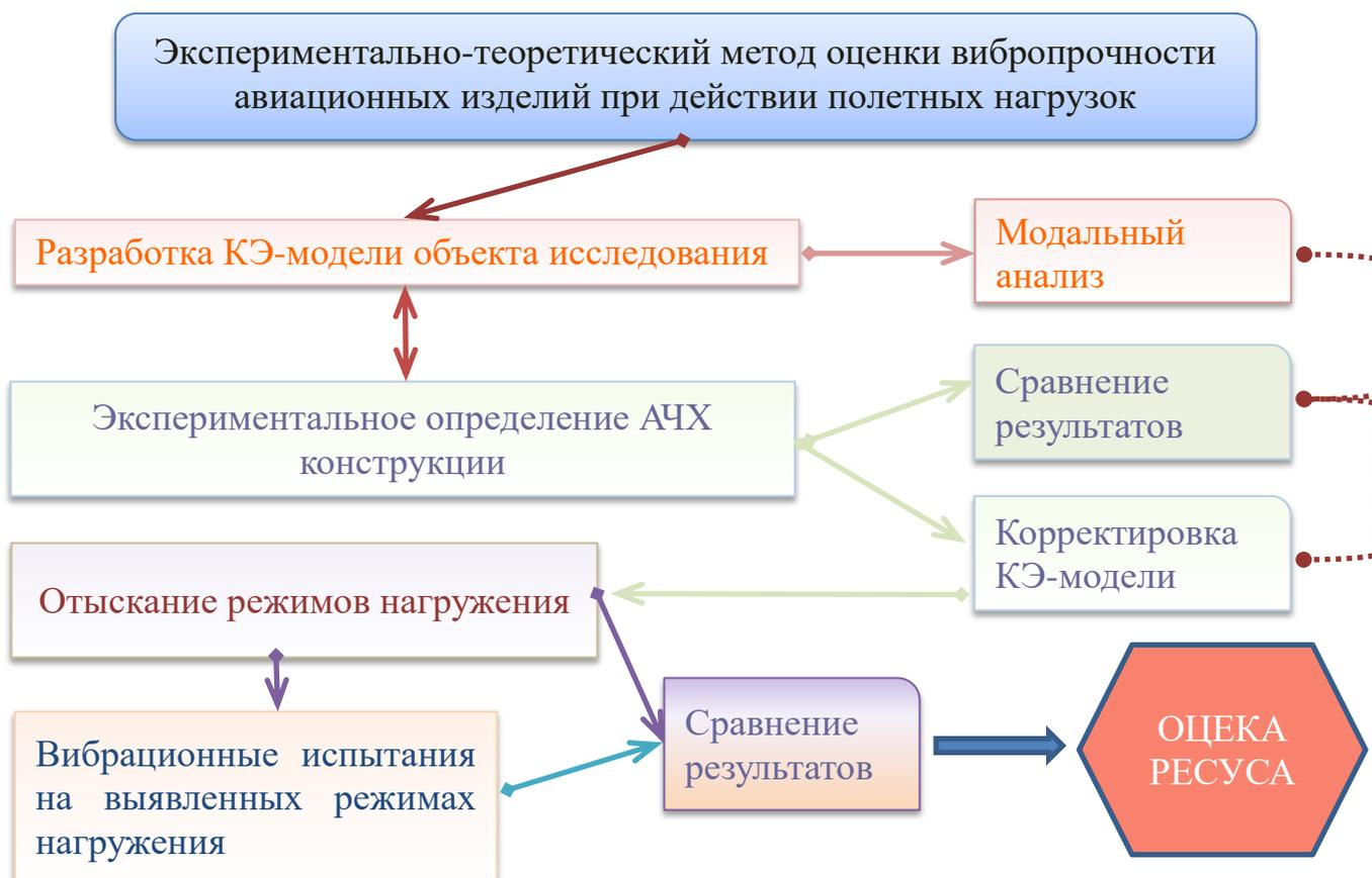
Рис. 3. Методика обоснования режимов лабораторных испытаний
