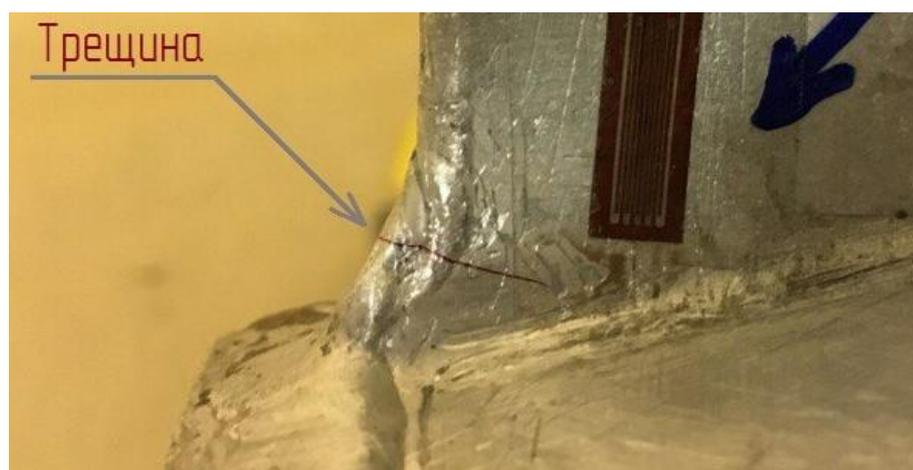
Рис. 8. Трещина в оперении хвостового отсека
