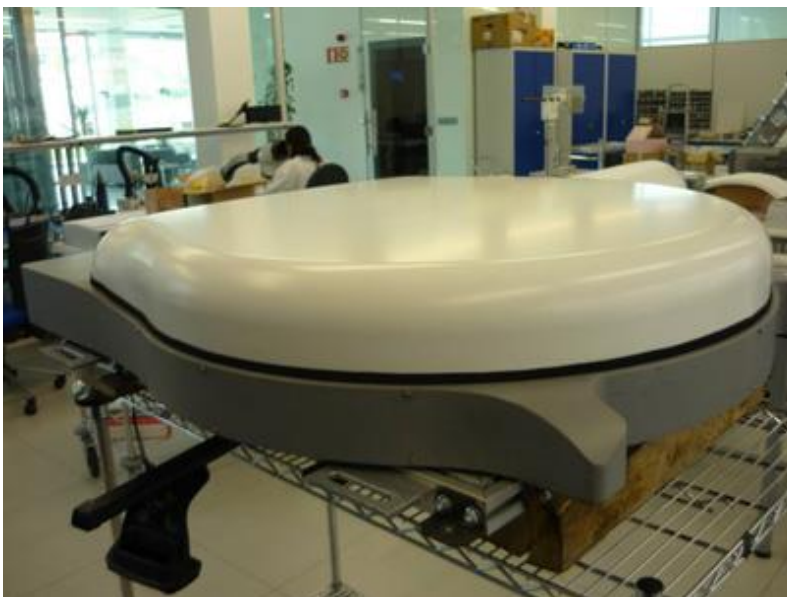
Рис.18. Фотография автомобильной антенной решетки спутникового телевидения с механическим сканированием, выпускаемой фирмой Thinsat
