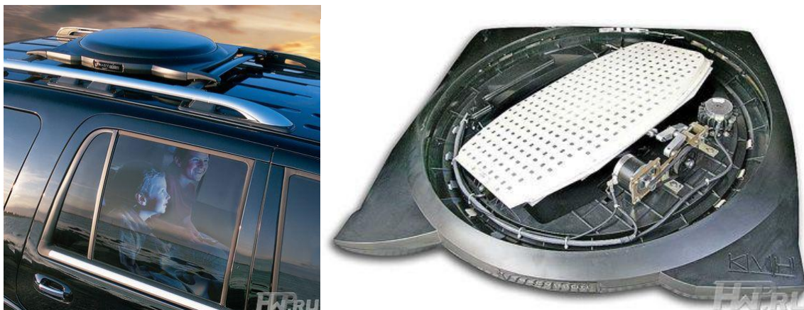
Рис.19. Антенные решетки с электрическим сканированием, изготовленные по печатной технологии
