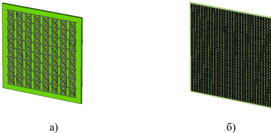
Рис.93. Антенная решетка из двухдиапазонных микрополосковых излучателей: а – с числом элементов N=64 , б – с числом элементов N=1024
