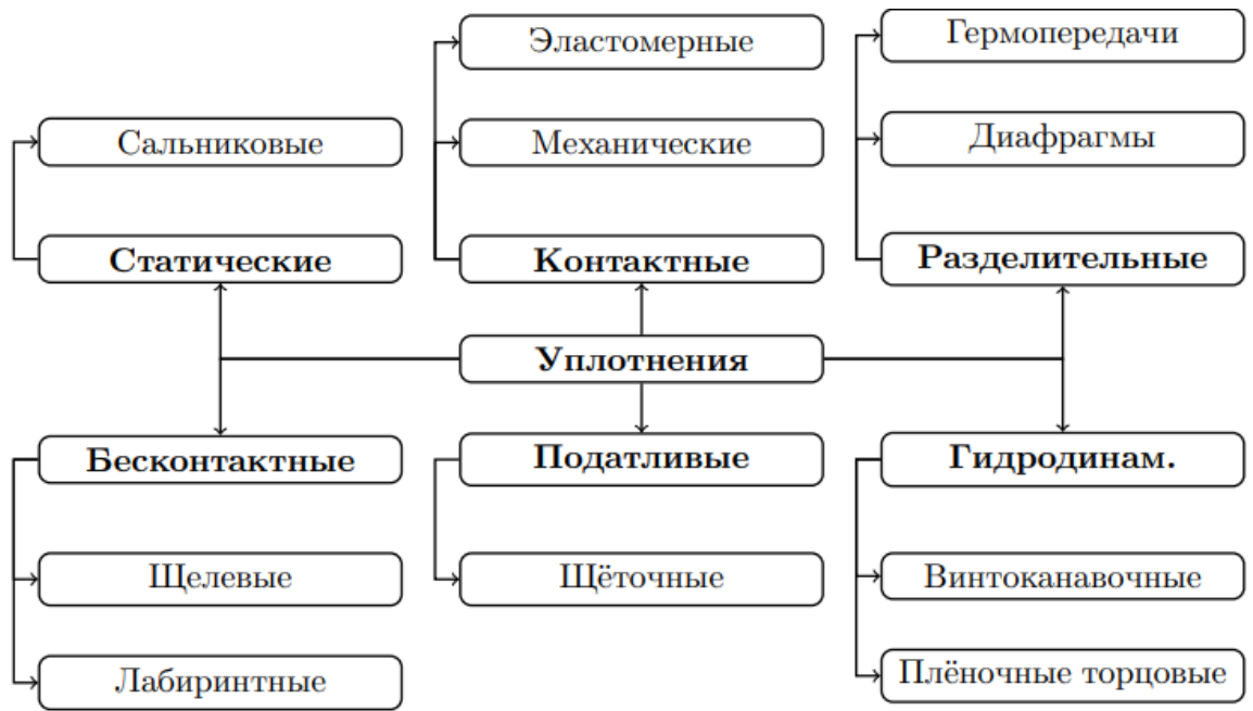
Рисунок 1.1 - Укрупнённая классификация уплотнений [1]
