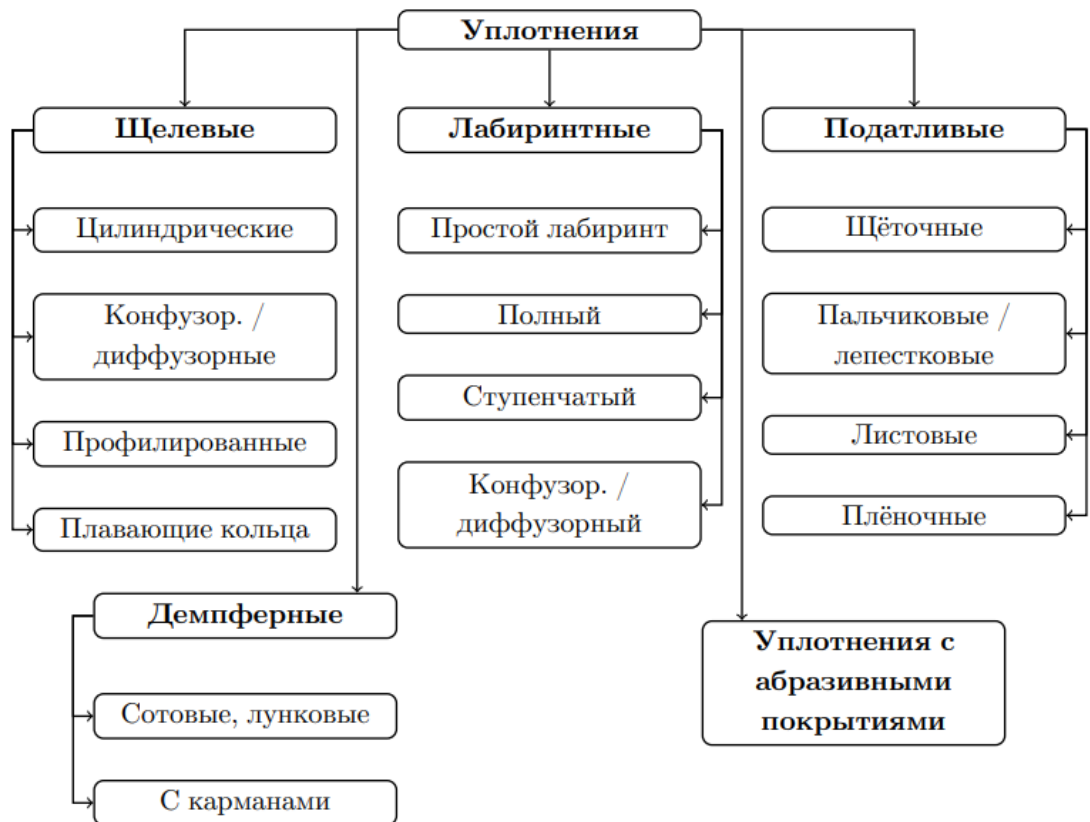
Рисунок 1.2 - Классификация бесконтактных и податливых уплотнений
