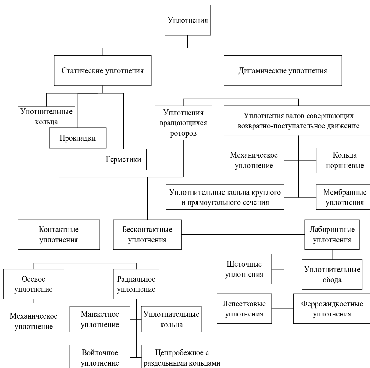
Рисунок 1.3 - Классификация уплотнений по зарубежным источникам
