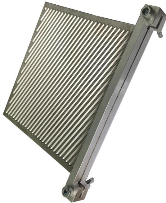
Рисунок 4.6 – Сварка пластин в конверт с помощью специального приспособления
