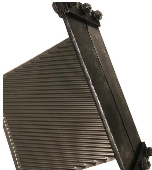
Рисунок 4.5 – Чеканка входных каналов пластин
