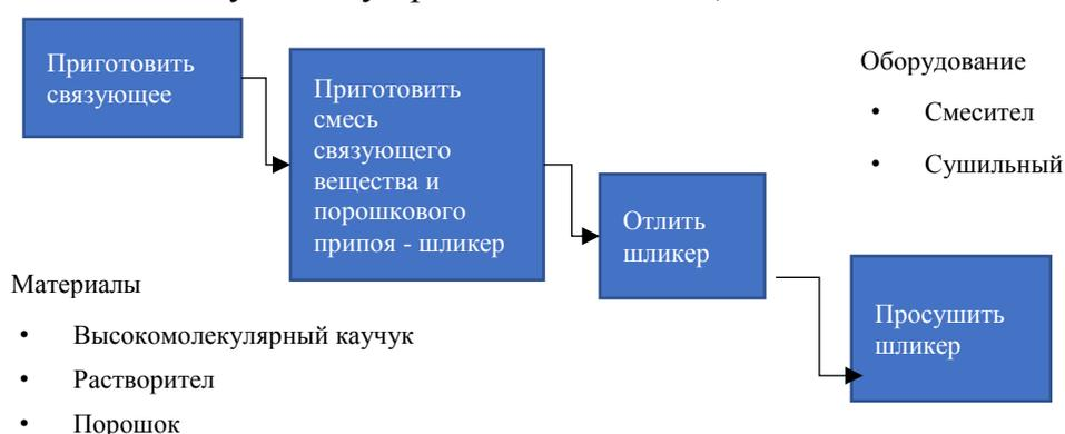
Рисунок 3 – Технологическая схема изготовления порошкового припоя в виде ленты.
