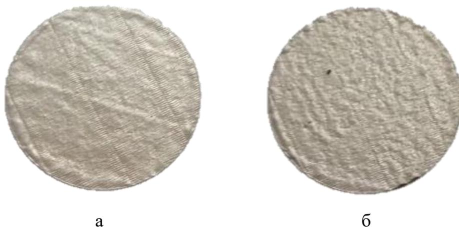
Рисунок 4.2 – Внешний вид образцов а) с островковой диагональной штриховкой, б) с зигзагообразной штриховкой
