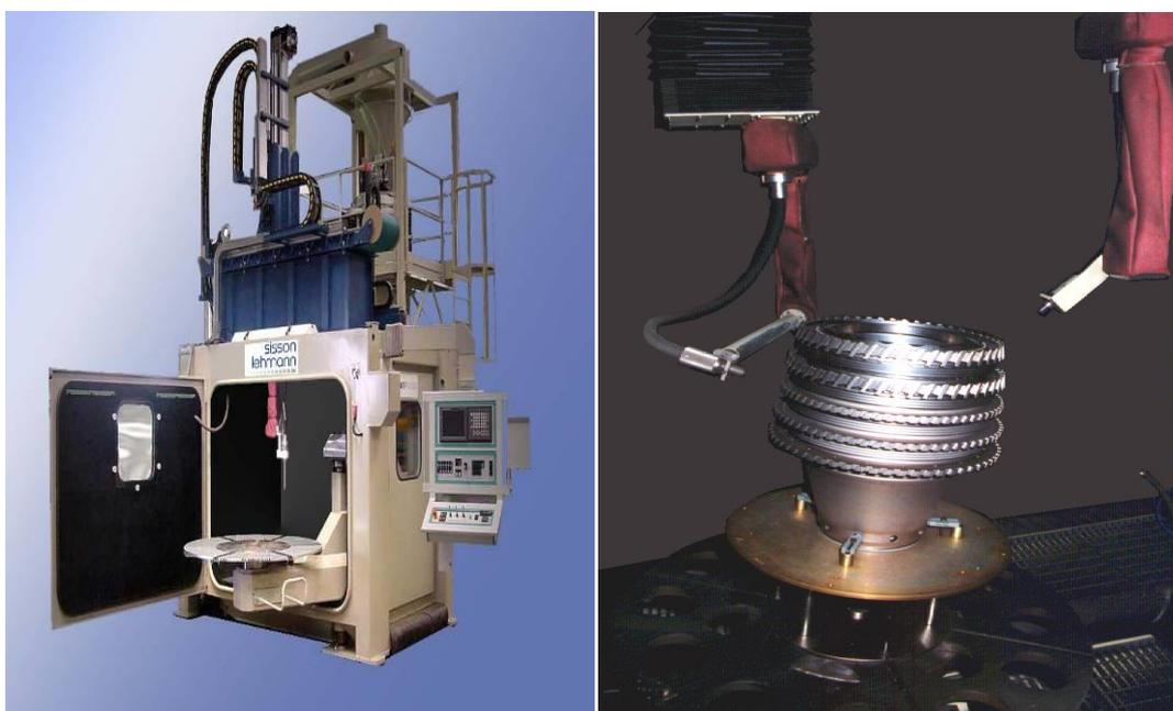
Рисунок 1.15 – Установка пневмодробеструйного упрочнения
