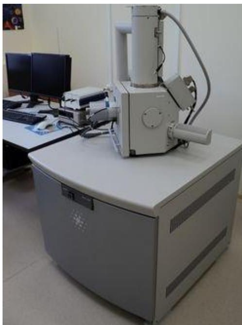
Рисунок 2.13 – Внешний вид микроскопа FEI Quanta 200
