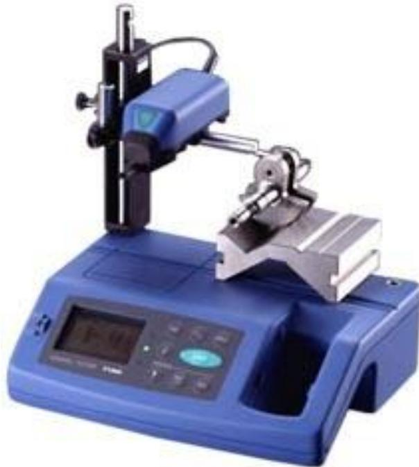
Рисунок 2.15 – Внешний вид профилометра HOMMEL TESTERT1000
