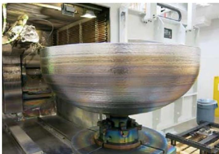
Рисунок 1.2 – Топливный бак, произведенный аддитивным методом
