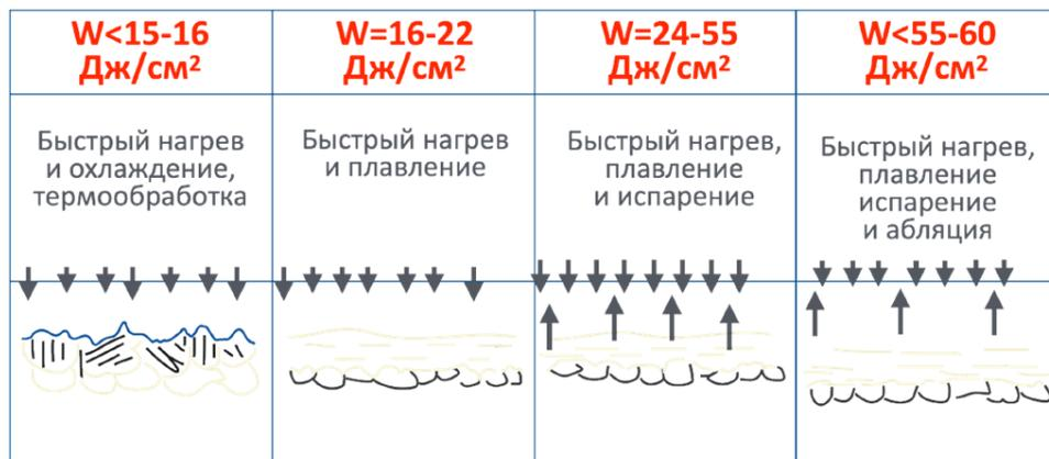
Рисунок 1.26 – Процессы, протекающие при облучении СИЭП в зависимости от плотности энергии
