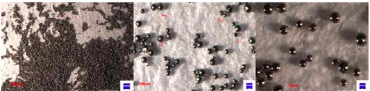
Рисунок 1.7 – Порошки для аддитивных технологий
