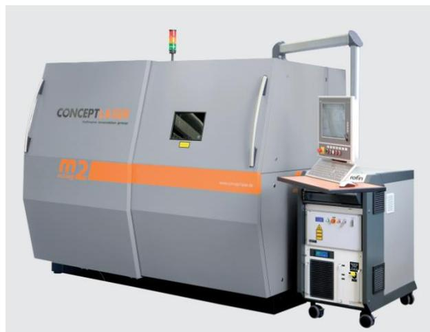
Рисунок 2.4 – Внешний вид установки Concept Laser M2 Cusing
