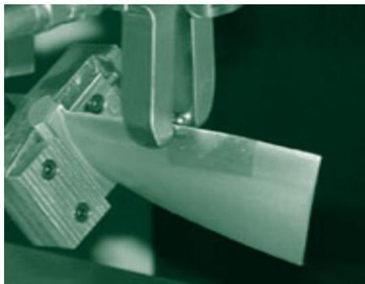
Рисунок 1.19 – Упрочнение кромок лопаток компрессора с помощью выглаживания шариком
