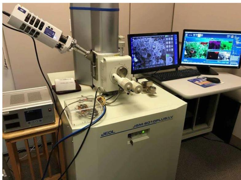
Рисунок 2.14 – Внешний вид рентгеновского микроанализатора Oxford X-Max 80T
