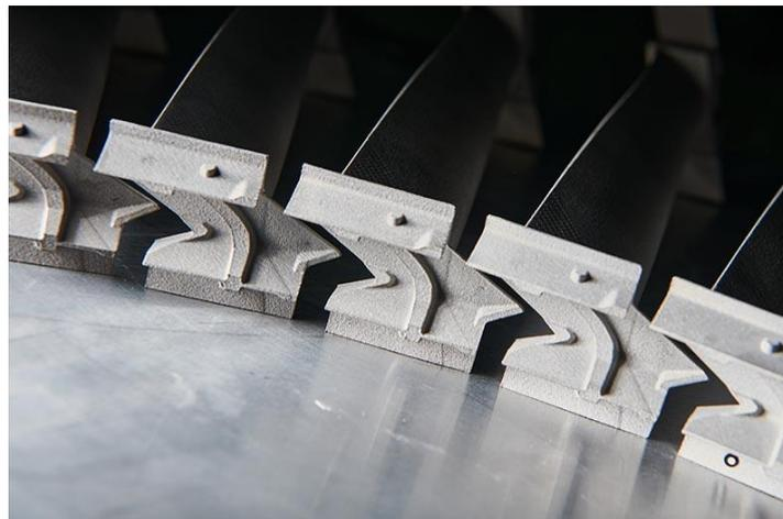
Рисунок 2.2 – Внешний вид рабочих лопаток, изготовленных из сплава КХ28М6
