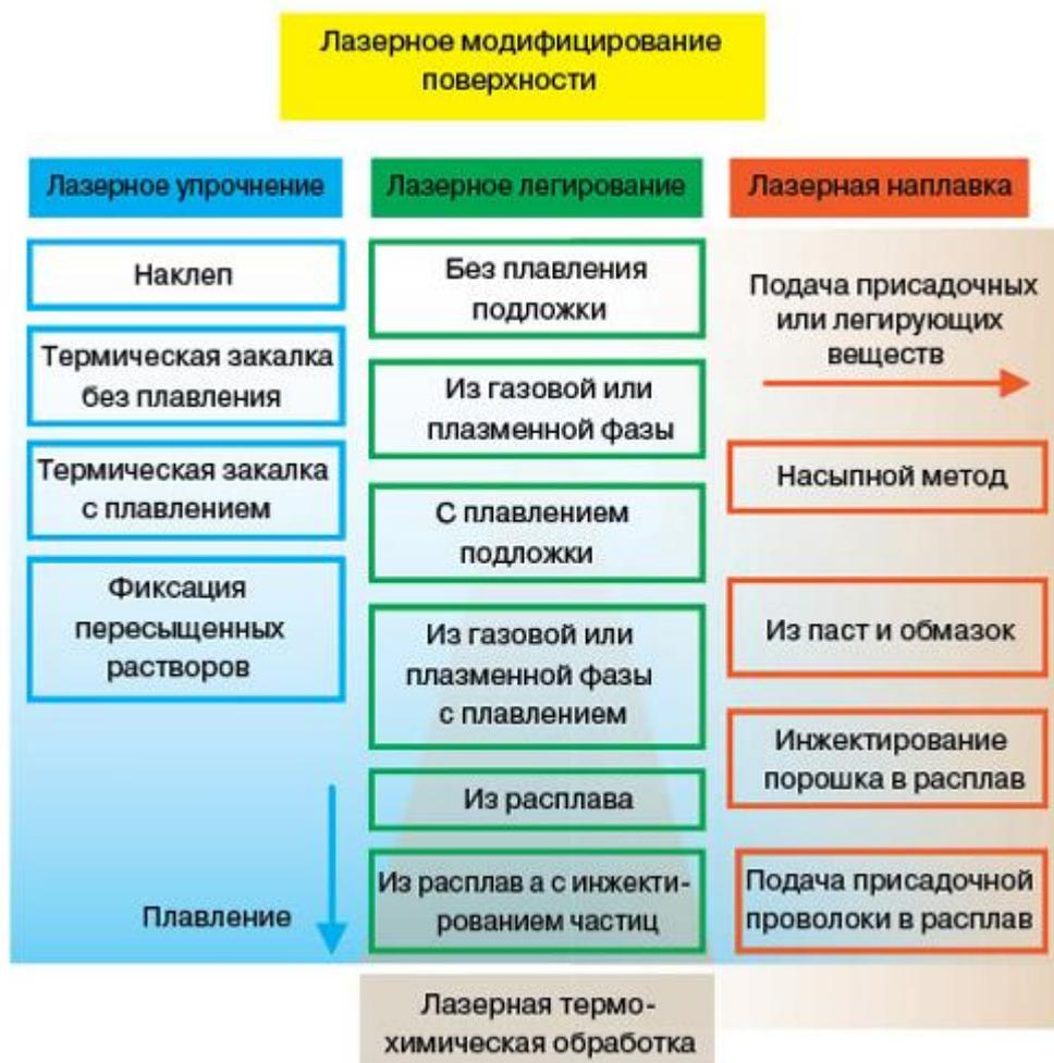
Рисунок 1.23 – Классификация методов лазерного модифицирования поверхности металлов
