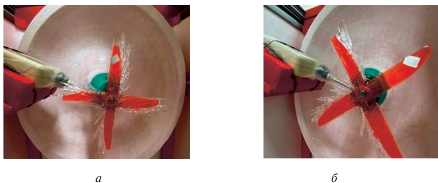
Рис. 3. Общий вид вентилятора: а – после намораживания льда; б – после схода льда с одной из лопастей
