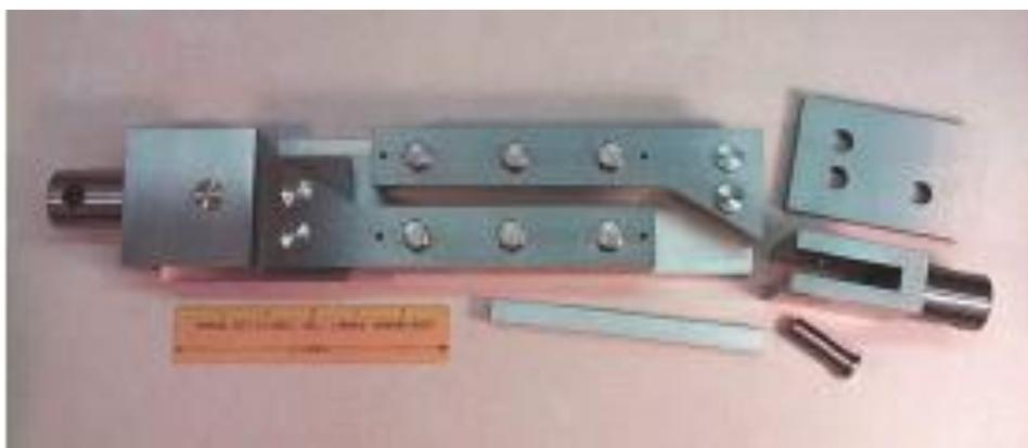
Рисунок 1.23 – Приспособление для испытания Two Rail Shear
