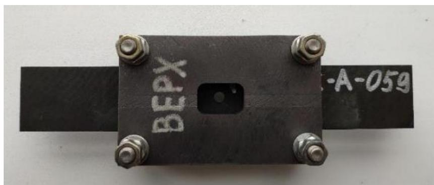
Рисунок 3.23 – Образец в противоизгибном приспособлении для испытания на сжатие
