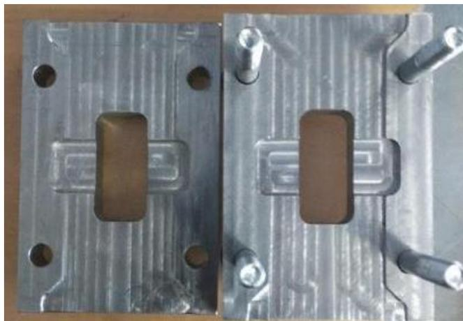
Рисунок 1.14 – Противоизгибное приспособление в соответствии с методикой «ЦАГИ»
