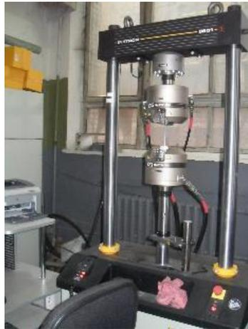
Рисунок 1.34 – Электрогидравлический стенд Instron-10
