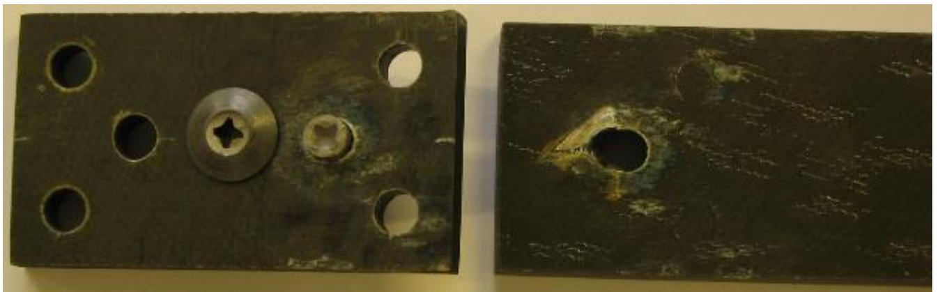
Рисунок 4.12 – Усталостные повреждения образца
