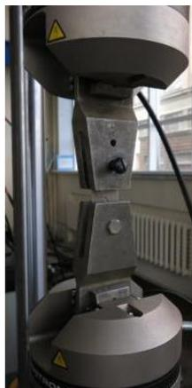
Рисунок 1.35 – Захваты с установленным в них образцом
