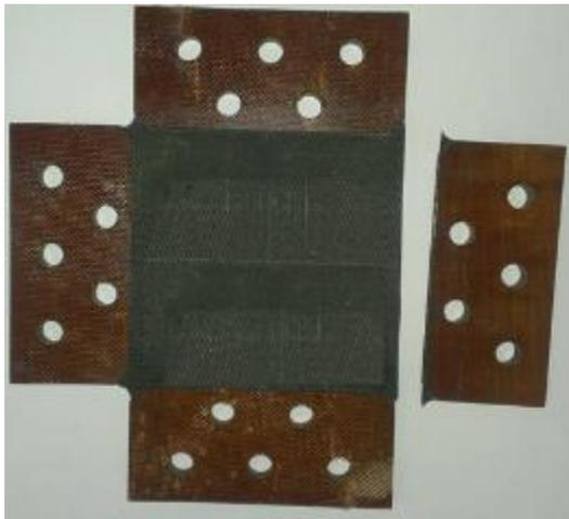
Рисунок 1.19 – Типовое незачетное разрушение по ГОСТ 24778-83
