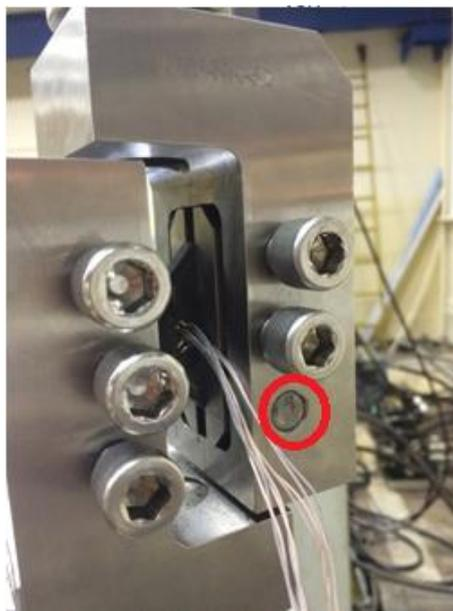
Рисунок 1.27 – Разрушение болта в стандартной оснастке.
