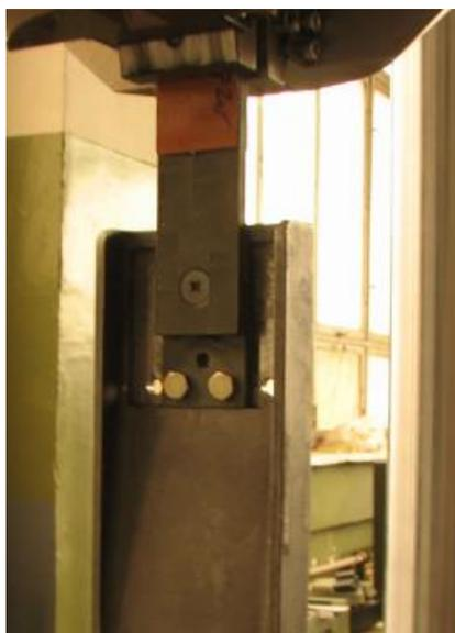
Рисунок 4.3 - Приспособление для испытания односрезного одноболтового соединения
