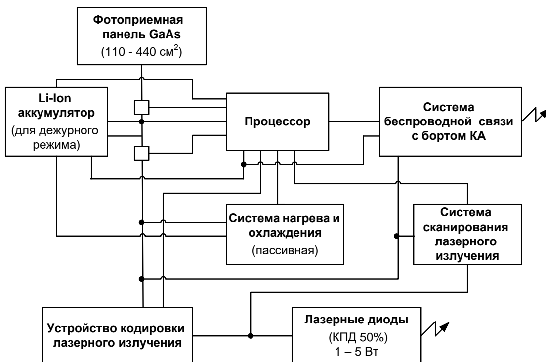
Рисунок 8. Функциональная схема автономных оптических лазерных маяков
