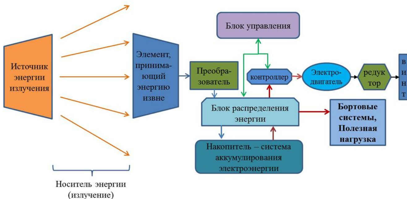
Рис. 1.9- Принципиальная схема работы систем дистанционной передачи энергии
