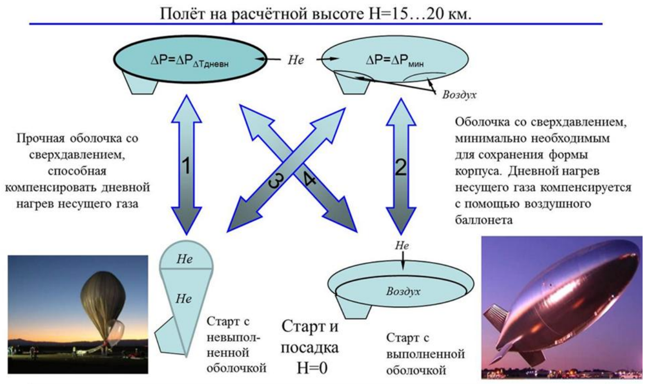
Рис. 3.8 - Варианты схемы функционирования оболочки высотного дирижабля
