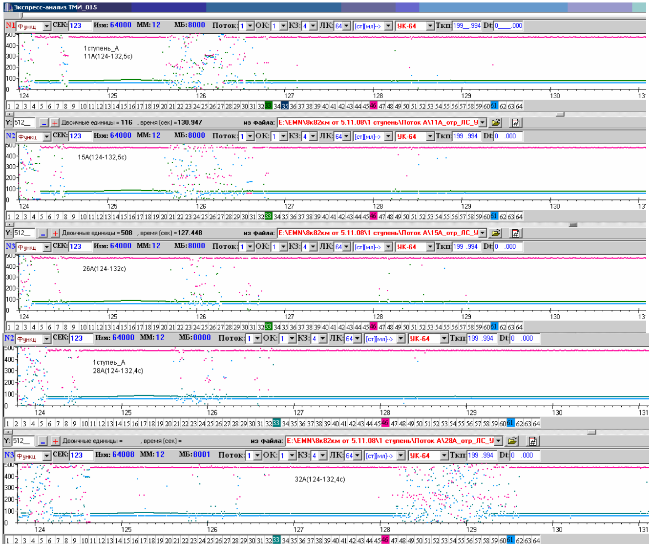
Рисунок Б.9 – Графики, иллюстрирующие результат действия помех в пяти каналах разнесения (ТМИ первой ступени РН «Протон-М» от 05.11.2008, f_{044, 090} ). Графики на рисунке (сверху вниз) ТМИ ПРС МК-11А, 15А, 26А, 28А, 32А
