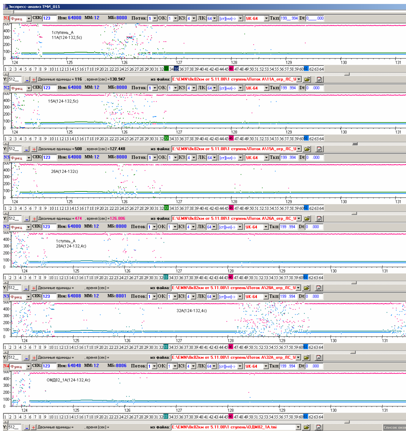
Рисунок Б.35 – Результаты применения алгоритма A_4 (ТМИ первой ступени РН «Протон-М» от 05.11.2008, f_{044, 090} , ПРС МК-11А, 15А, 26А, 28А, 32А). Графики на рисунке (сверху вниз): МК-11А, 15А, 26А, 28А, 32А, 28А, 32А обобщённый массив
