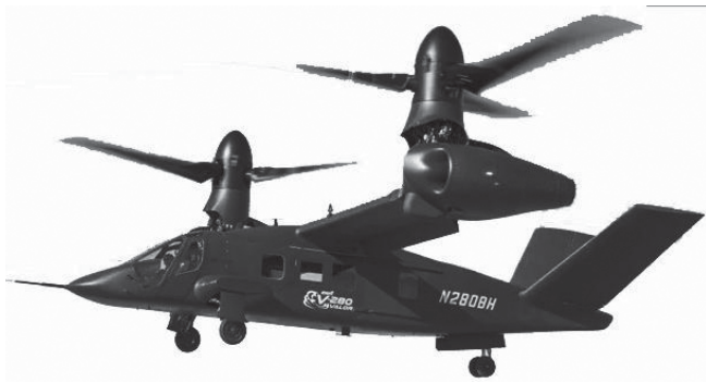
Конвертоплан Bell V-280 Valor ( V = 520 км/ч)
