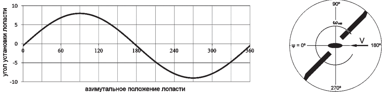
Рис. 12. Предварительный закон управления для НВ «синхροптера»
