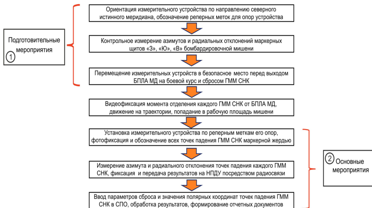
Рис. 2. Алгоритм реализации способа оперативной оценки отклонений СНК
