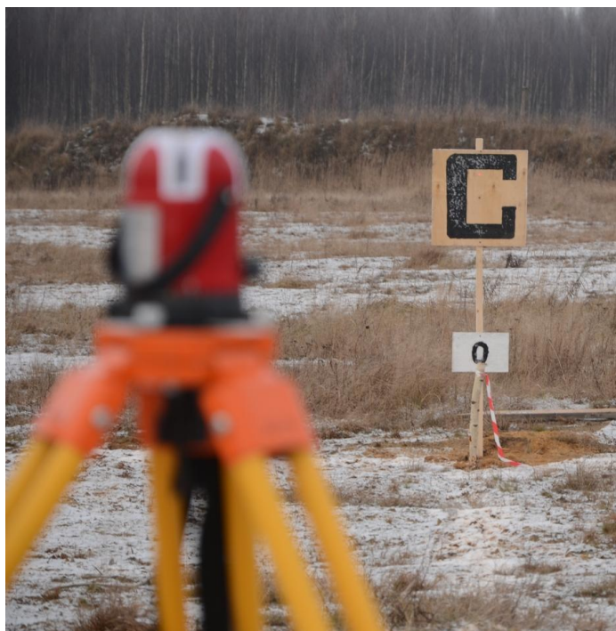
Рис. 3. Ориентация светодальномерного устройства
