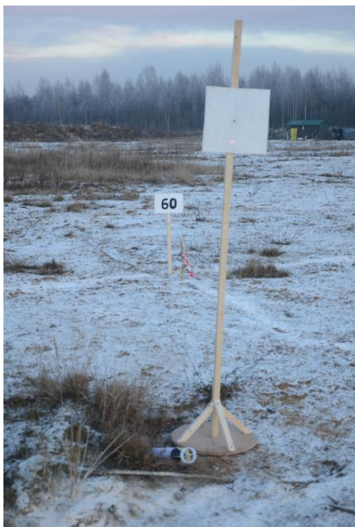
Рис. 4. Иллюстрация измерения координат точки падения ГММ СНК
