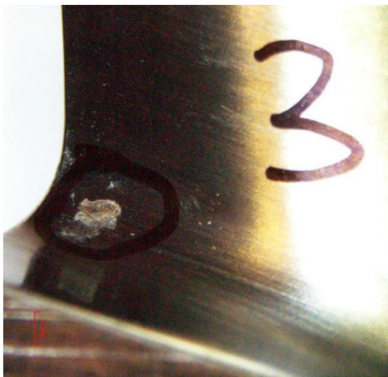
Рисунок 5.2 – Дефект на поверхности лопатки ввиду некачественного нанесения абляционного покрытия
