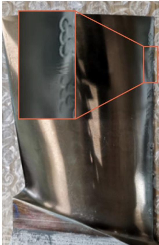
Рисунок 5.5 – Обработка кромки лопатки методом ЛУО
