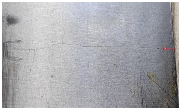
Рисунок 5.6 – Трещина лопатке после проведения усталостных испытаний
