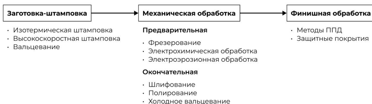
Рисунок 1.6 – Схема принципиального технологического процесса изготовления лопатки ГТД
