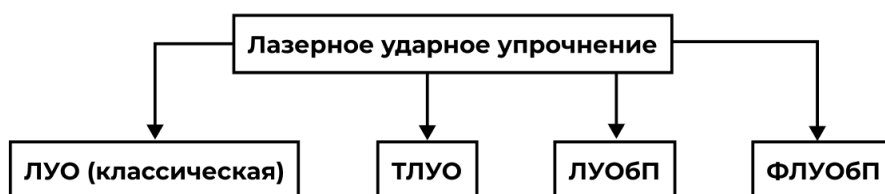
Рисунок 2.3 – Классификация методов лазерного ударного упрочнения
