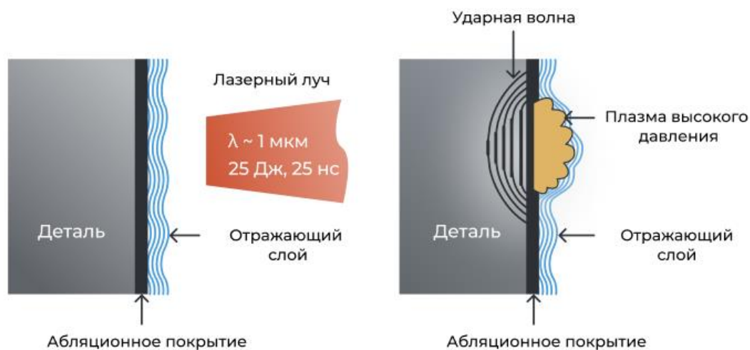
Рисунок 1.9 – Принципиальная схема лазерной ударной обработки. [50]
