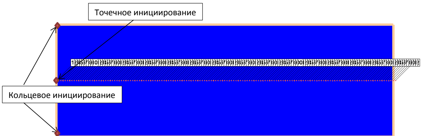
Рисунок 3.8 – Расчетная схема при исследовании способа инициирования
