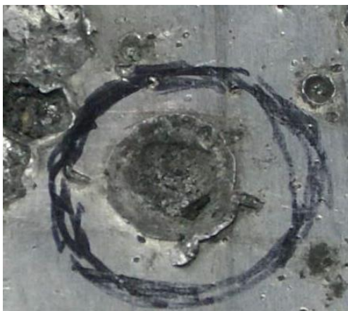
Рисунок 4.10 – Характерный вид полубесконечной преграды (алюминиевой плиты) после воздействия ВМУ. Выстрел произведен горизонтально. Расстояние от ВМУ до преграды ~ 2 м. Точечное инициирование. Без отсечки низкоскоростной части струи
