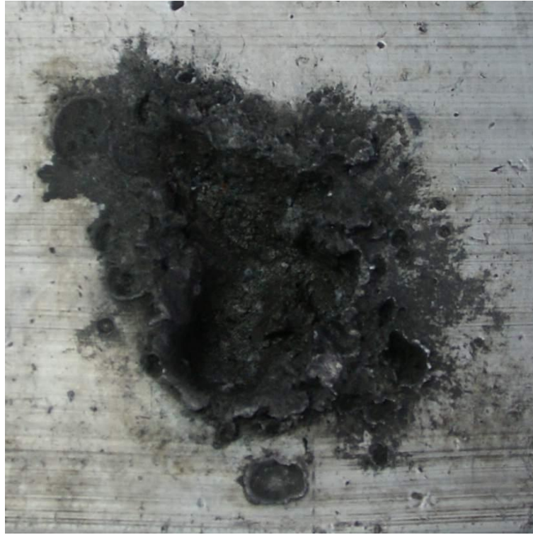
Рисунок 4.11 – Характерный вид полубесконечной преграды (алюминиевой плиты) после воздействия ВМУ. Выстрел произведен вертикально. Расстояние от ВМУ до преграды около 0,5 м. Кольцевое инициирование
