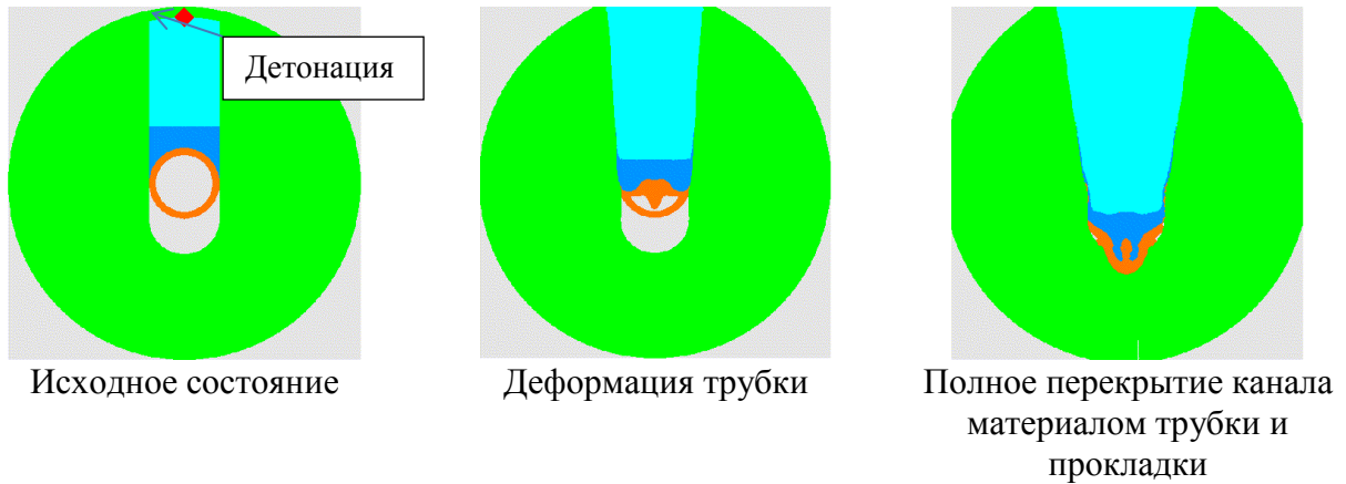
Рисунок 3.44 – Процесс отсечки низкоскоростной части струи
