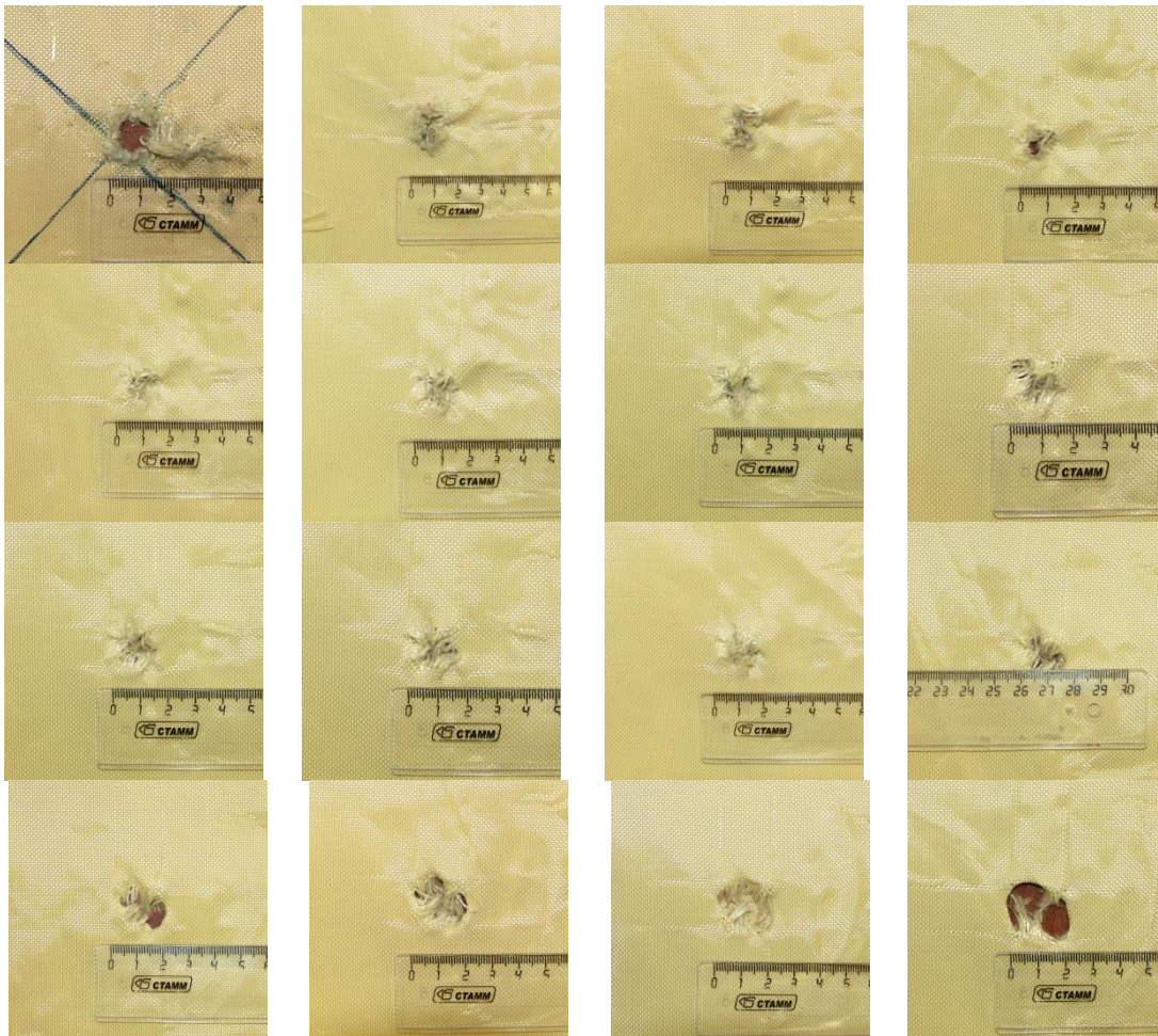
Рисунок 2.7 – Повреждения фрагментов тканевого экрана в эксперименте № 1
