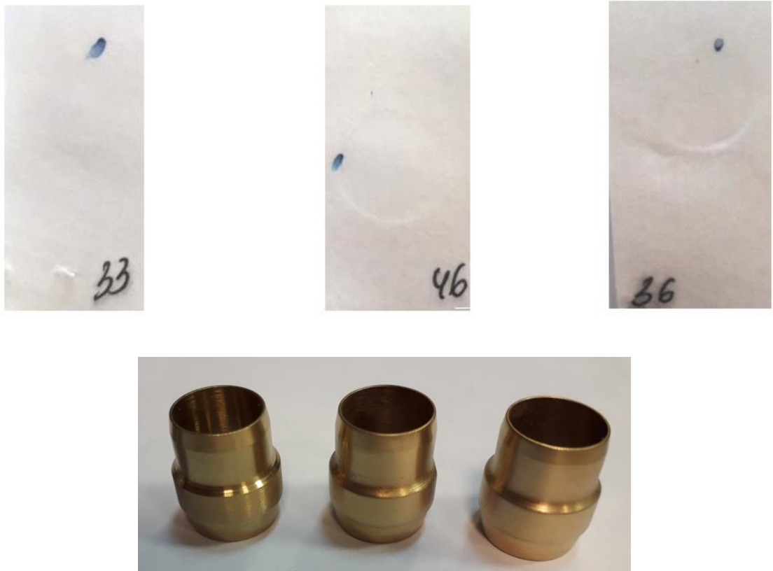
Рисунок 5.14 – Внешний вид ниппелей ОСТ 1 12926-77 с коррозионностойким и защитным покрытием системы Ti-Zr-N на стали ЭИ 961 и фильтровальной бумаги после определения сплошности покрытия по ГОСТ 9.308.
