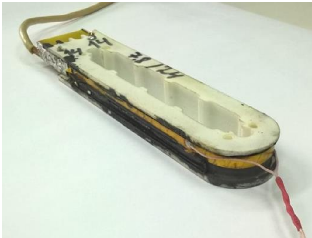
Рисунок 6.1 – Внешний вид исследуемой ВТСП катушки
