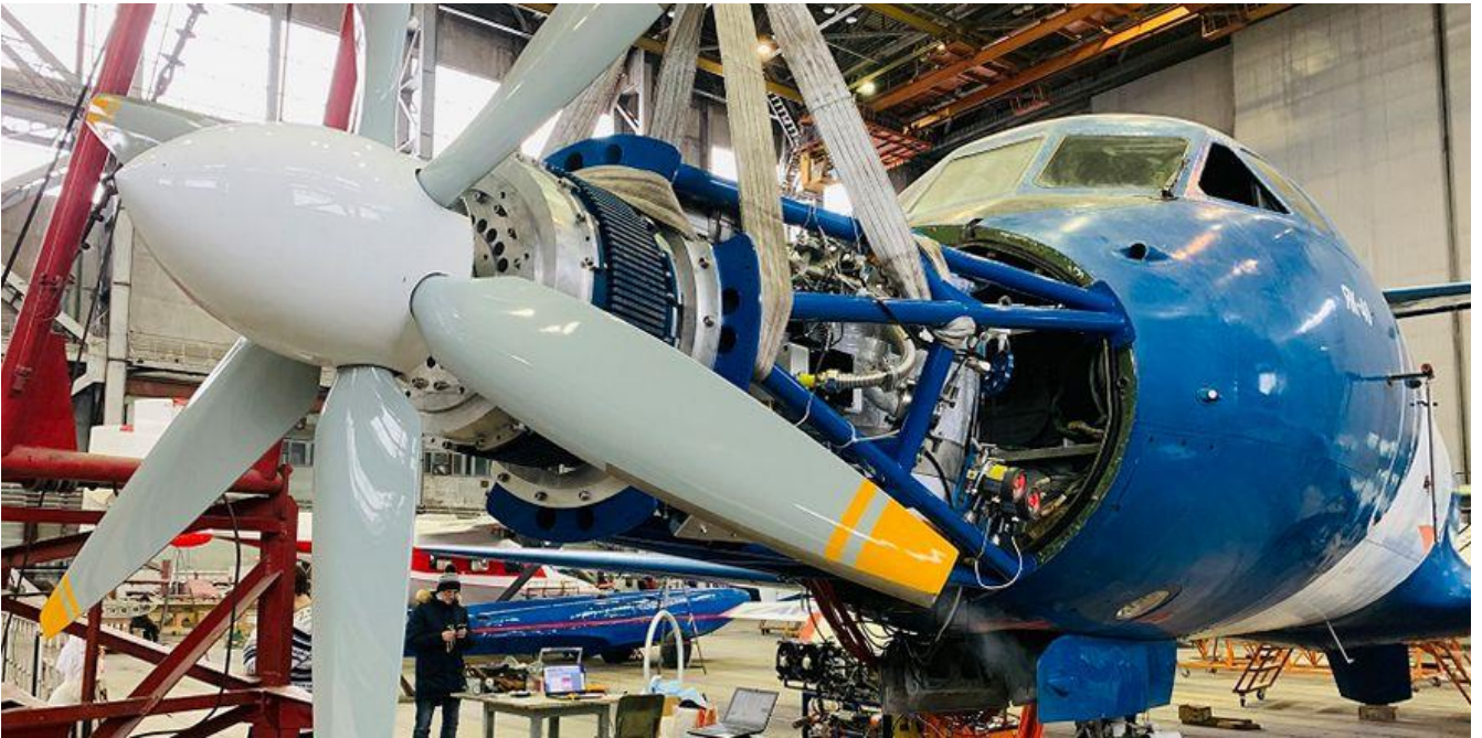
Рисунок 1.3 – ВСТП двигатель компании «СуперОкс» в процессе установки на летающую лабораторию Як-40ЛЛ
