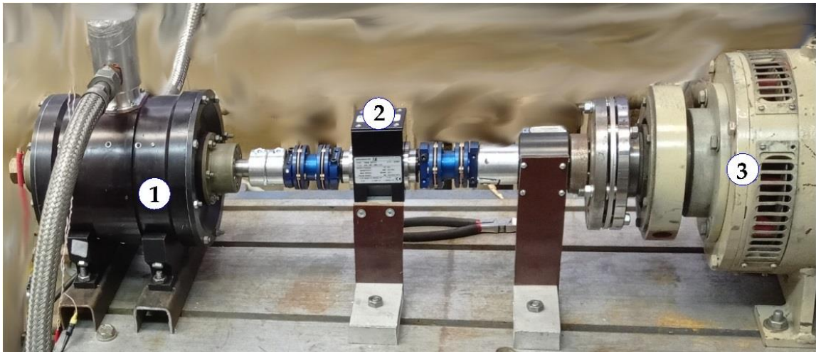
Рисунок 6.18 – Стенд для испытаний электрических машин:
