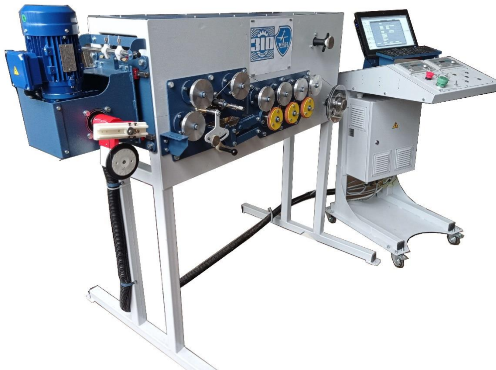
Рисунок 4.3 – Станок для намотки ВСПП катушек
