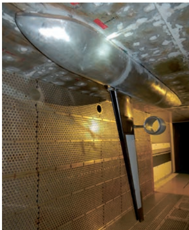
Рис. 1. Аэродинамическая полумодель регионального самолета с ламинарным крылом и щитками Крюгера в АДТ Т-128
