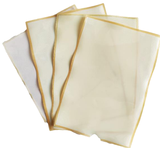
Рисунок 8 – Общий вид получаемых пленочных \text{TiO}_2 /ЭП композиционных материалов
