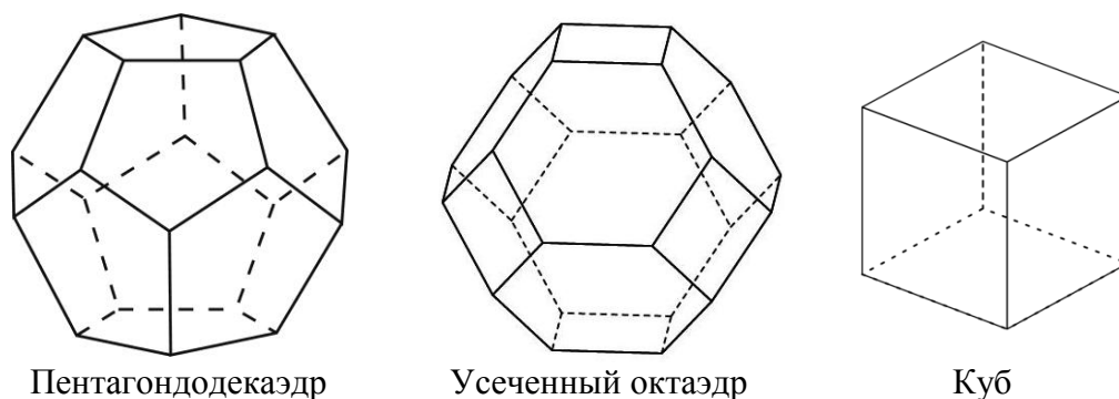
Рис. 1.6 – Геометрические модели элементарной ячейки ВПЯМ
