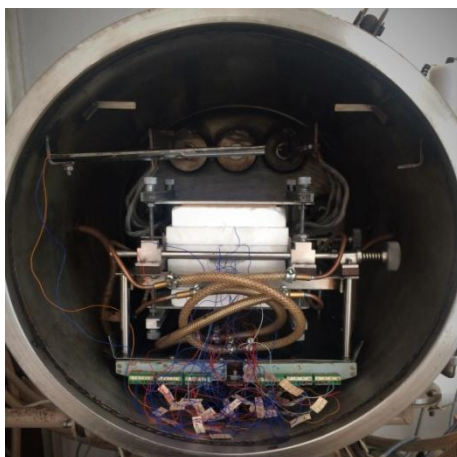
Рис. 5.16 – Модуль ЭМ-2В в вакуумной камере стенда ТВС-1М
