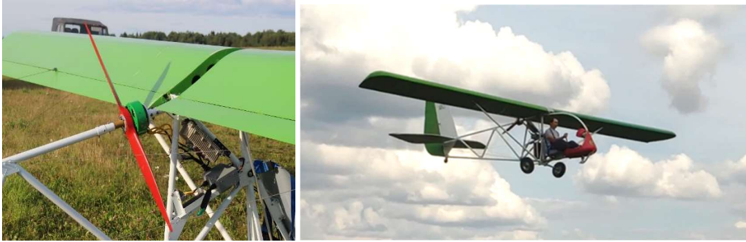
Рисунок 11. Компановка ЭВМГ и экспериментальный самолёт в полёте
