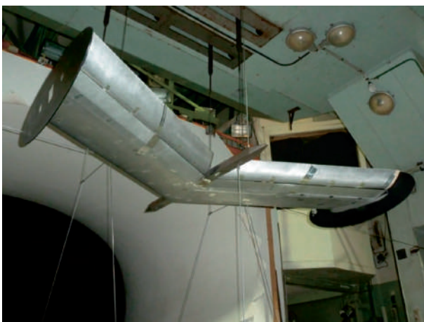
Рис. 11. Модель ТМК-1 в ходе весовых испытаний в АДТ
