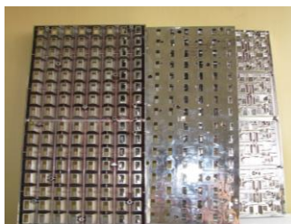
Рис.26. Фотография распределительной системы приемной антенной решетки спутникового телевидения, выполненной по технологии гальванопластики
