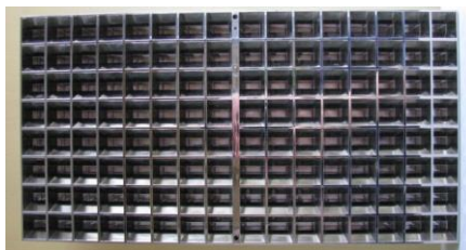
Рис.24. Фотография антенного полотна системы приемной антенной решетки спутникового телевидения, выполненной по технологии гальванопластики
