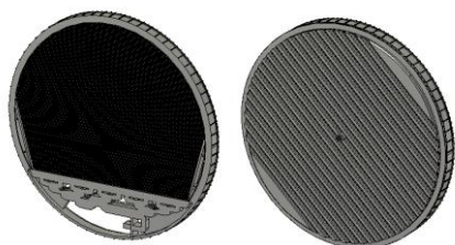
Рис.29. Модель низкопрофильного антенного модуля спутниковой связи сантиметрового диапазона волн с широкоугольным механическим сканированием.
