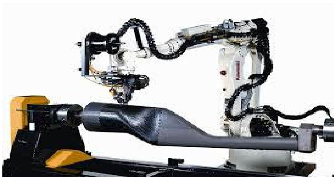
Рисунок 11 – Выкладочная головка фирмы «Automated Dynamics» США для производства композитных конструкций по аддитивной технологии
