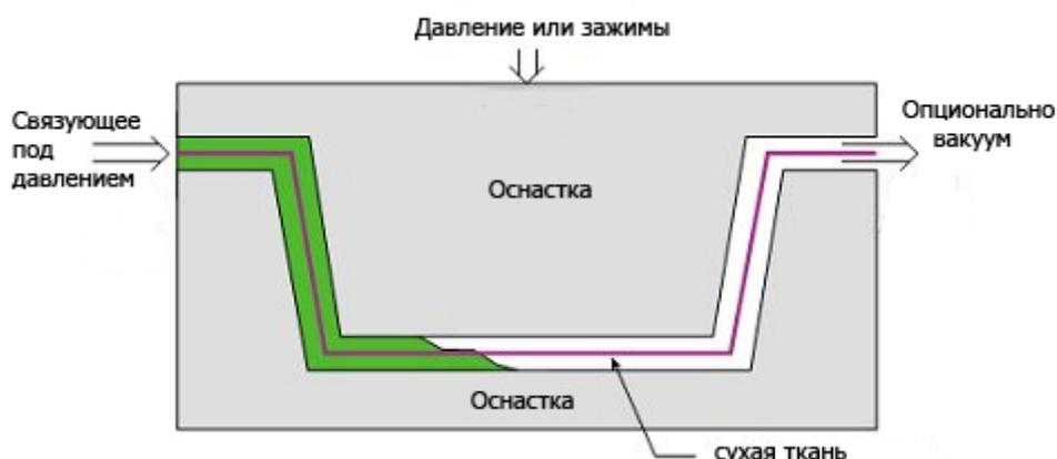
Рисунок 7 – Схема метода РТМ
