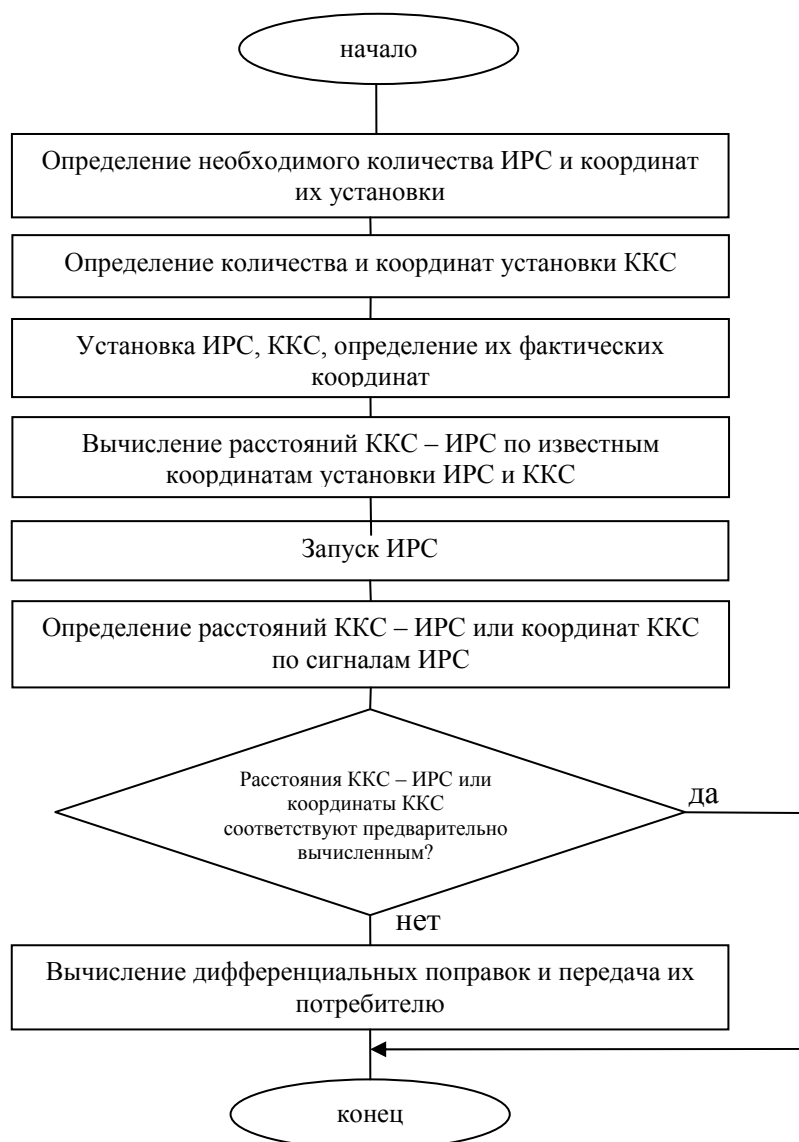
Рис. 9. Блок схема алгоритма формирования ЛРП ЛРС с использованием ККС распространяющей корректирующую информацию.
