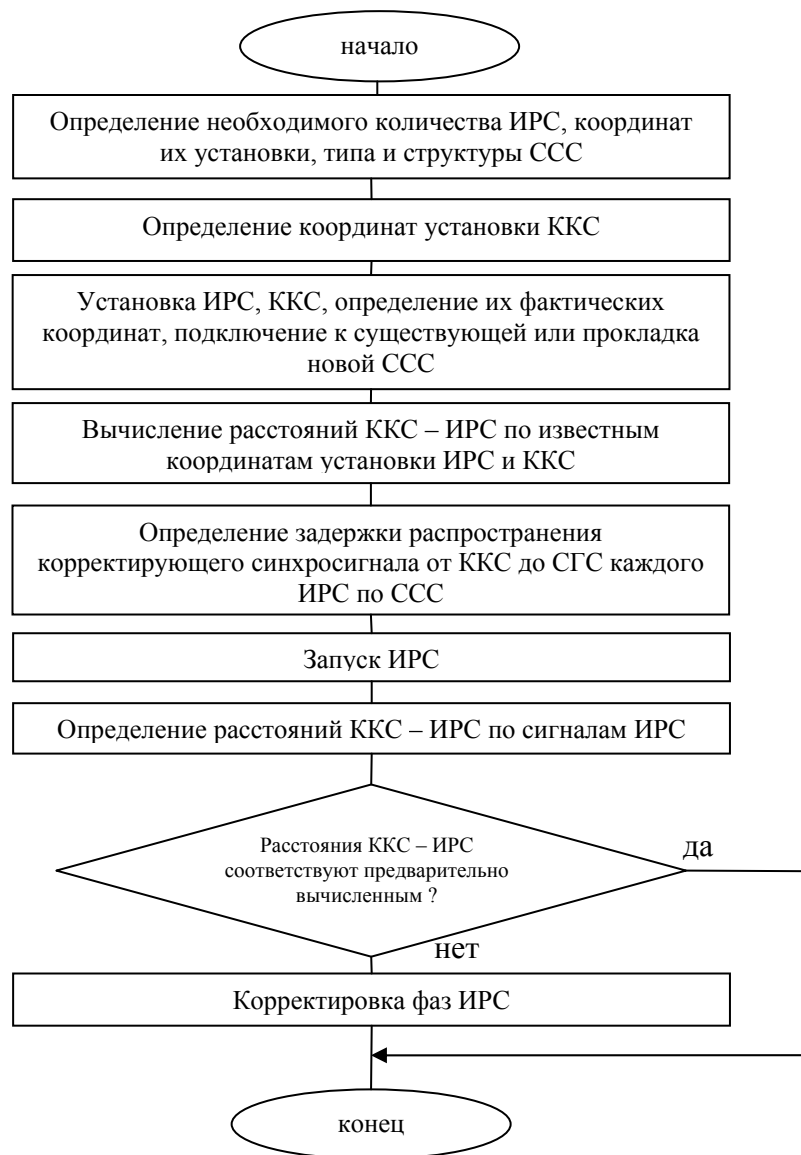
Рис. 7. Блок схема алгоритма формирования ЛРП автономной ЛРС с синхронизацией ИРС ККС.
