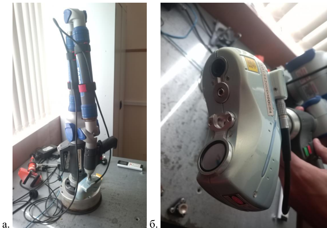
рисунок 4.2. Процесс сканирования оболочки (а – КИМ лазерного сканера, б – лазерная насадка)
