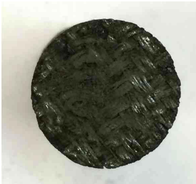
1 – образец с тонким слоем SiC до испытаний, 2 – защитная втулка Рисунок 5.21. Вид модели для испытаний образца УУКМ с тонким поверхностным слоем SiC
