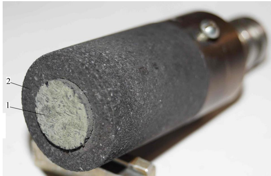
1 – образец с тонким слоем SiC до испытаний, 2 – защитная втулка Рисунок 5.21. Вид модели для испытаний образца УУКМ с тонким поверхностным слоем SiC
