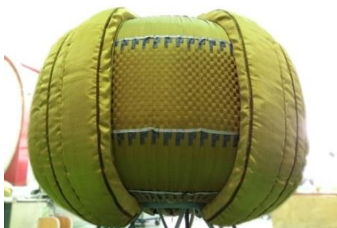
Рисунок 2 – Макет трансформируемого модуля РКК «Энергия»
