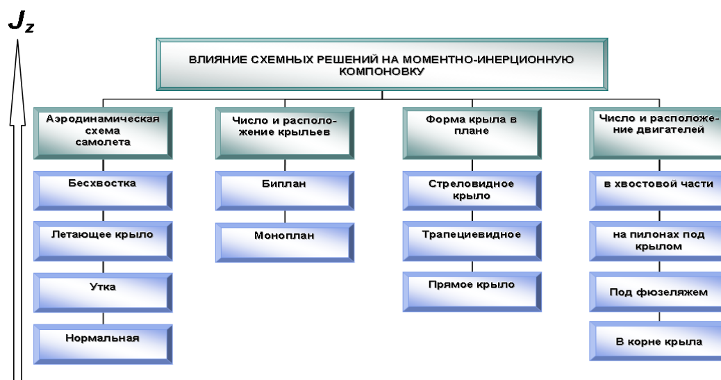
Рис.7. Влияние схемных решений на моментно-инерционную компоновку относительно оси OZ
