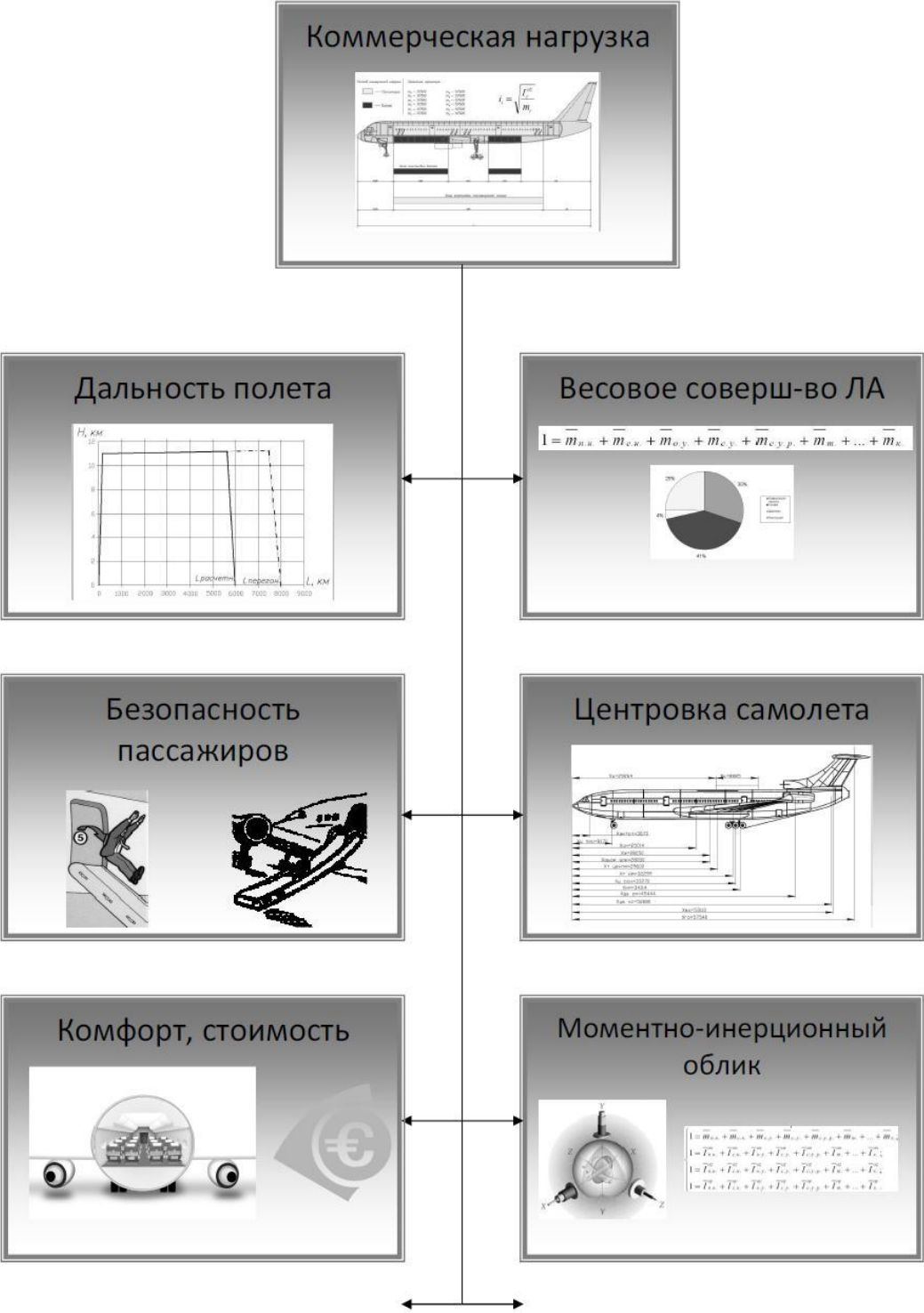
Рис. 6. Влияние параметров компоновки коммерческой нагрузки на облик самолета
