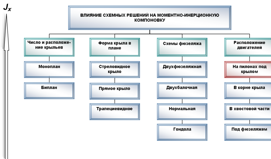
Рис. 3. Влияние схемных решений на моментно-инерционную компоновку относительно оси OX
