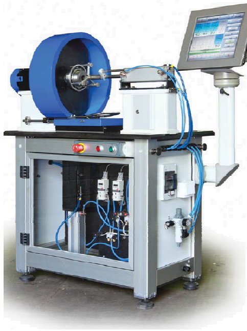
Рис. 5.21 Стенд входного контроля подшипников СП-180М
