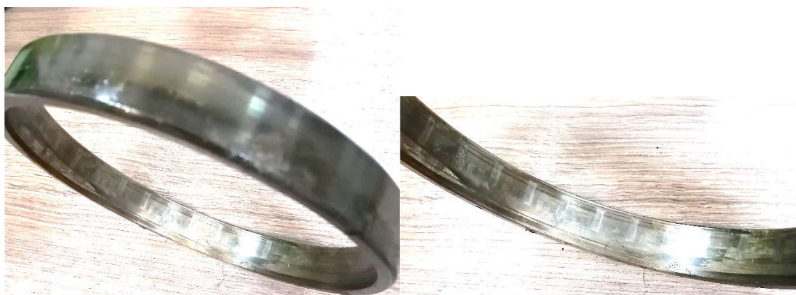
Рис. 5.32 Дефекты наружного кольца подшипника
