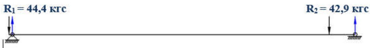
Рис. 4.4 Расчетная схема и результаты расчета реакций в опорах, действующих от дисбаланса ротора ВД
