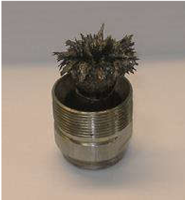
Рис. 5.17 Магнитная пробка после испытаний подшипника
