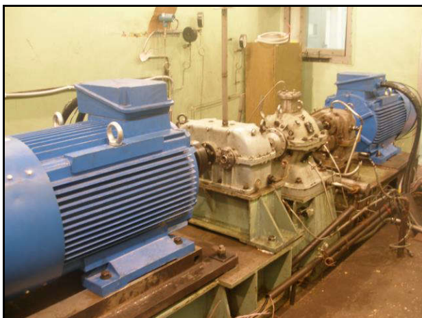
Рис. 5.1 Стенд Т14-15/1 для испытаний межроторных подшипников
