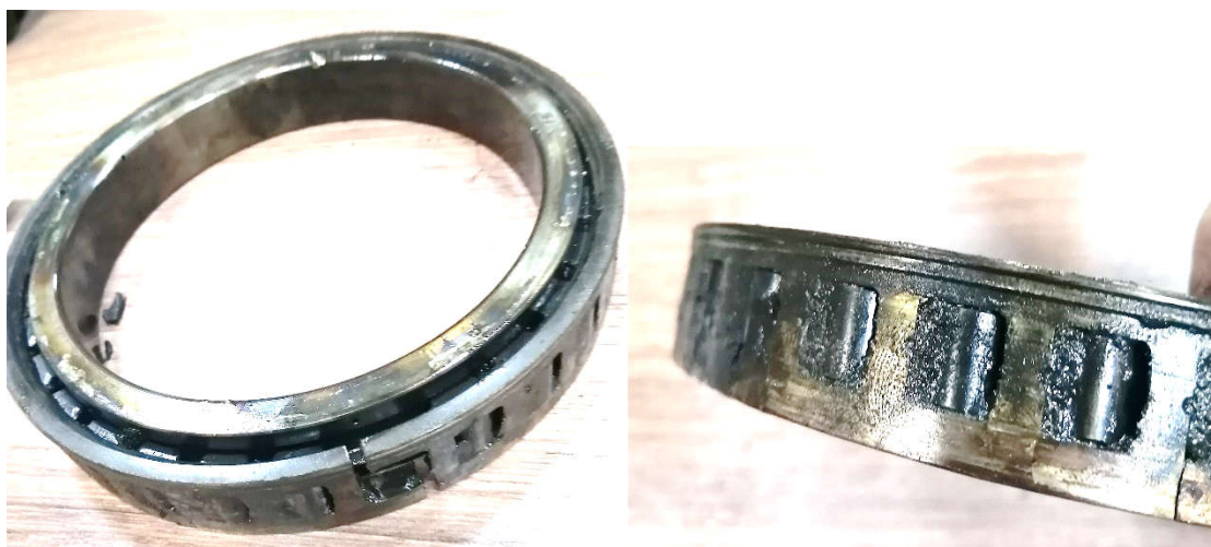
Рис. 5.31 Элементы подшипника после испытаний
