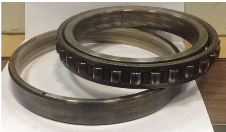
Рис. 5.20 Исследуемый роликоподшипник после подтверждения ресурса 2000 часов при его эксплуатации в межроторной опоре перспективного двигателя
