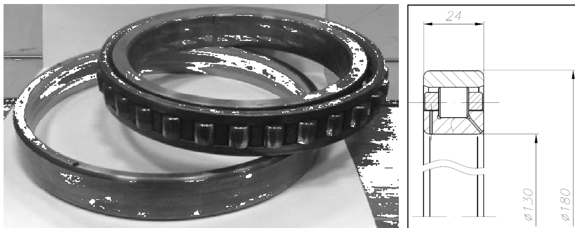
Рис. 4.1 Межроторный радиальный роликоподшипник 5AB1002926P4
