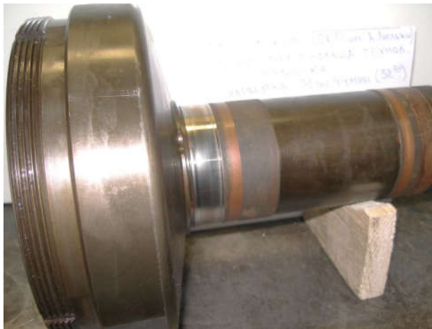
Рис. 5.18 Выработка на вале привода наружного кольца испытуемого подшипника
