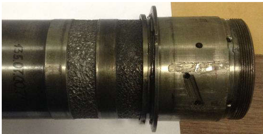
Рис. 5.19 Выработка в местах установки технологических подшипников узла нагружения на вале привода внутреннего кольца испытуемого подшипника
