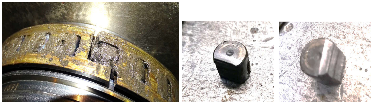
Рис. 5.33 Сепаратор и ролики после разрушения подшипника
