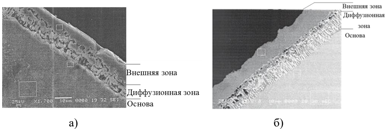
Рисунок 3.8 - Структура покрытия, полученного газовым кобальтхромоалитированием на образцах из сплава ЖС32 (а) и ЧС88У (б)
