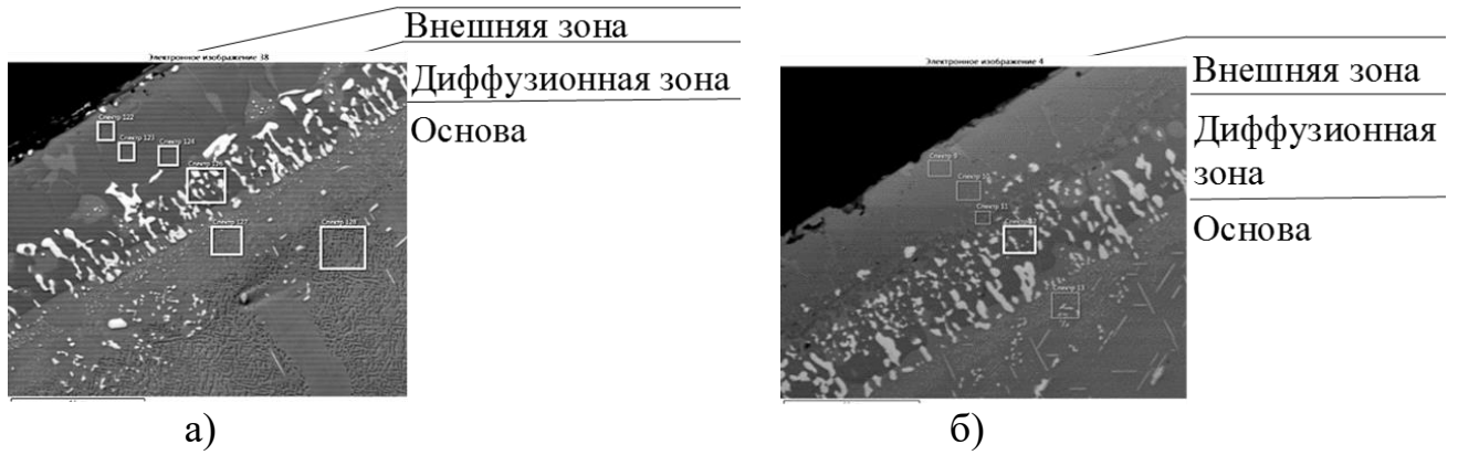
Рисунок 4.9 - Структура покрытий, полученных газовым алитированием (а) и хромоалитированием (б) с вакуумно-плазменным напылением ВСДП-11 на образцах из сплава ЖС26-ВИ после 200 часов испытаний на жаростойкость при температуре 1050 °С
