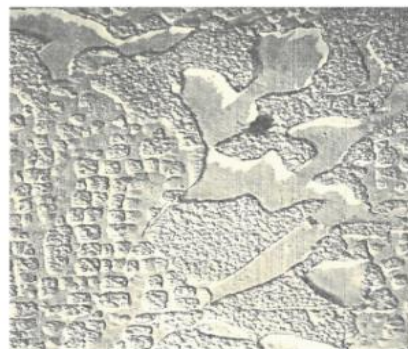
Рисунок 1.3 – Скелет карбидов Cr_{23}C_6 в лопатках турбины из сплава ЖС6КП
