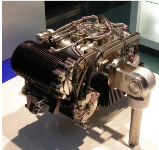
Рисунок 1.12 - Комбинированный привод фирмы «Liebherr-Aerospace» для управления спойлерами А-380
