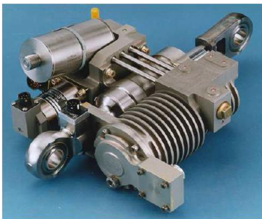
Рисунок 1.9 - Демонстратор ЭГСтП элерона с матричным конвертером, испытанный в составе системы управления самолета А-320
