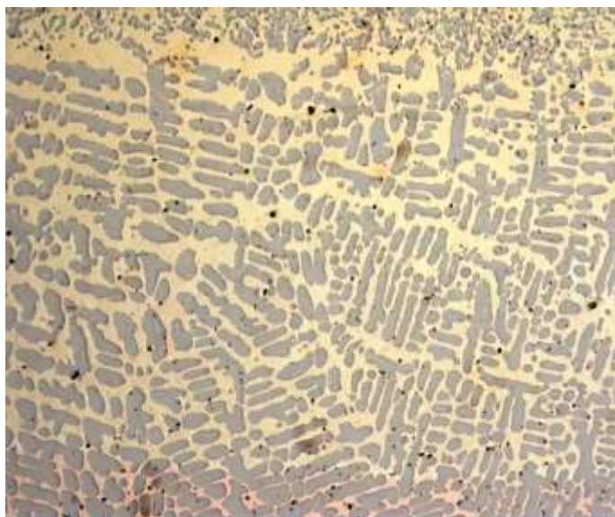
Рисунок 2.3 – Микроструктура сплава Cu–Ag
