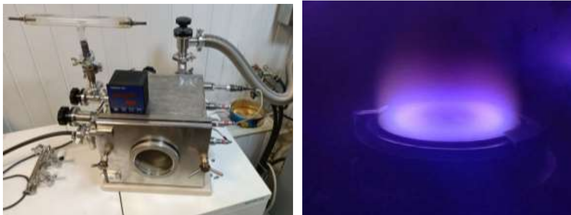
Рисунок 5.5 – Нанесение поверхностной тонкой пленки тантала на подложку из сплава ВТ1-0 магнетронным распылением
