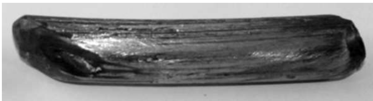
Рисунок 3.1 – Внешний вид образца титанового сплава ВТ1-0 после проведения 16 циклов РКУ-прессования
