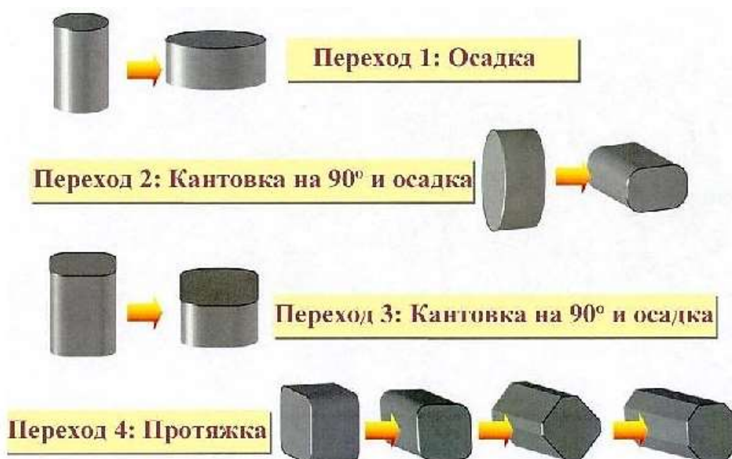
Рисунок 1.8 – Принципиальная схема процесса всесторонней изотермическойковки
