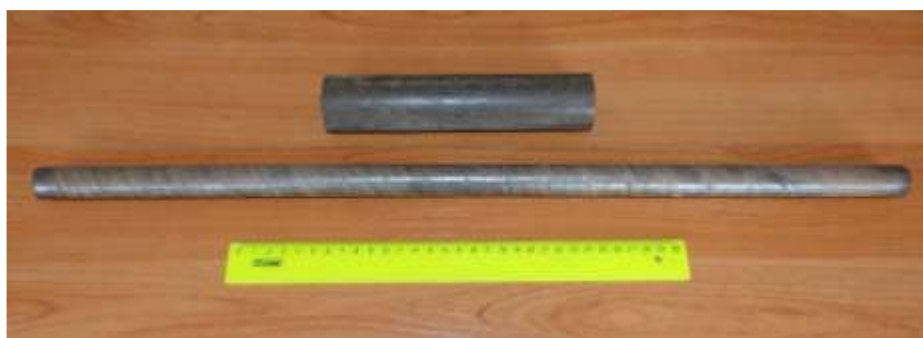
Рисунок 3.6 – Пруток сплава ВТ1-0 после РКУП (сверху) и после дополнительного волочения (внизу)
