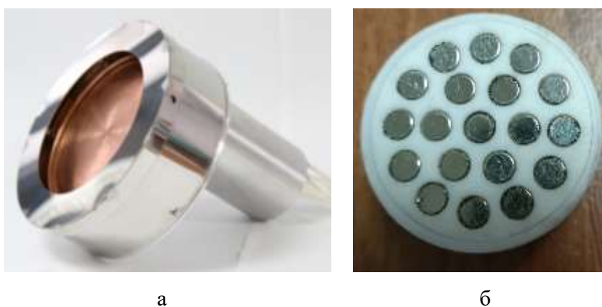
Рисунок 2.6 – Магнетрон в сборе (а) и магнитная система (б) магнетрона на основе постоянных магнитов
