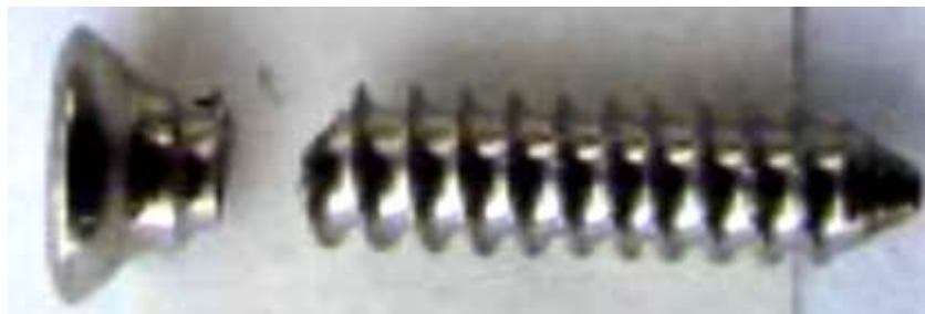
Рисунок 5.13 – Внешний вид кортикальных винтов до (а) и после (б) испытаний
