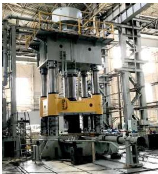
Рисунок 2.1 – Пресс для равноканального углового прессования заготовок из титановых сплавов
