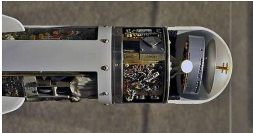
Рисунок 1.3 - Типичное устройство бортового оборудования в ГСН
