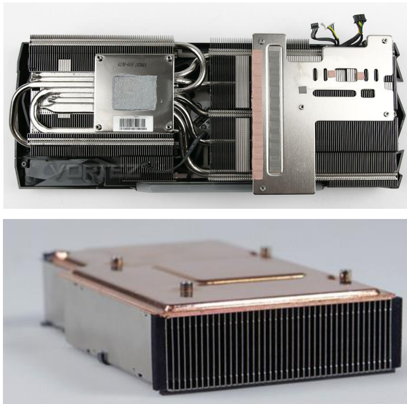
Рисунок 1.5 - Пример использования плоских тепловых труб в видеокартах RTX 2080 Ti (сверху) и ASUS GeForce GTX 680 (снизу) [40, 41], которые устанавливаются под процессором и ОЗУ
