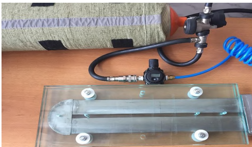
Рис. 9. Испытательный стенд с цилиндрическими оболочками эллиптического сечения
