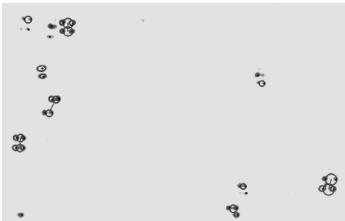
Рис. 8. Пример использования процедуры валидации по смещению парных бликов. Показано наложение результатов обработки двух последовательных изображений. Линиями показано смещение капель.
