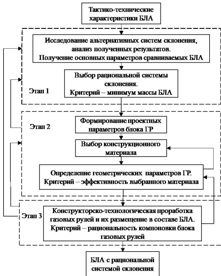
Рисунок 1 – Блок-схема метода определения проектных параметров блока ГР в составе системы склонения БЛА
