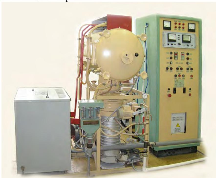
Рисунок 2.4 Вакуумная электропечь СНВЭ
