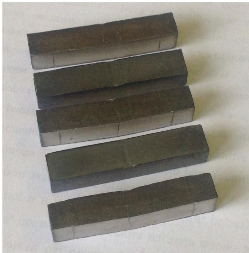
Рисунок 4.8 - Вид образцов, после проведения испытания на предел прочности при 3-х точечном изгибе. Разрушение – «книжка»
