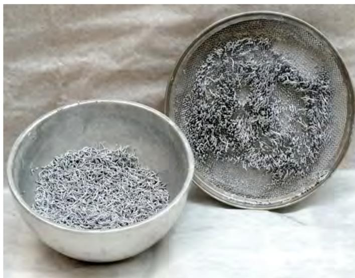
Рисунок 4.1 – Процесс образования гранул путем протирки влажной массы через сито
