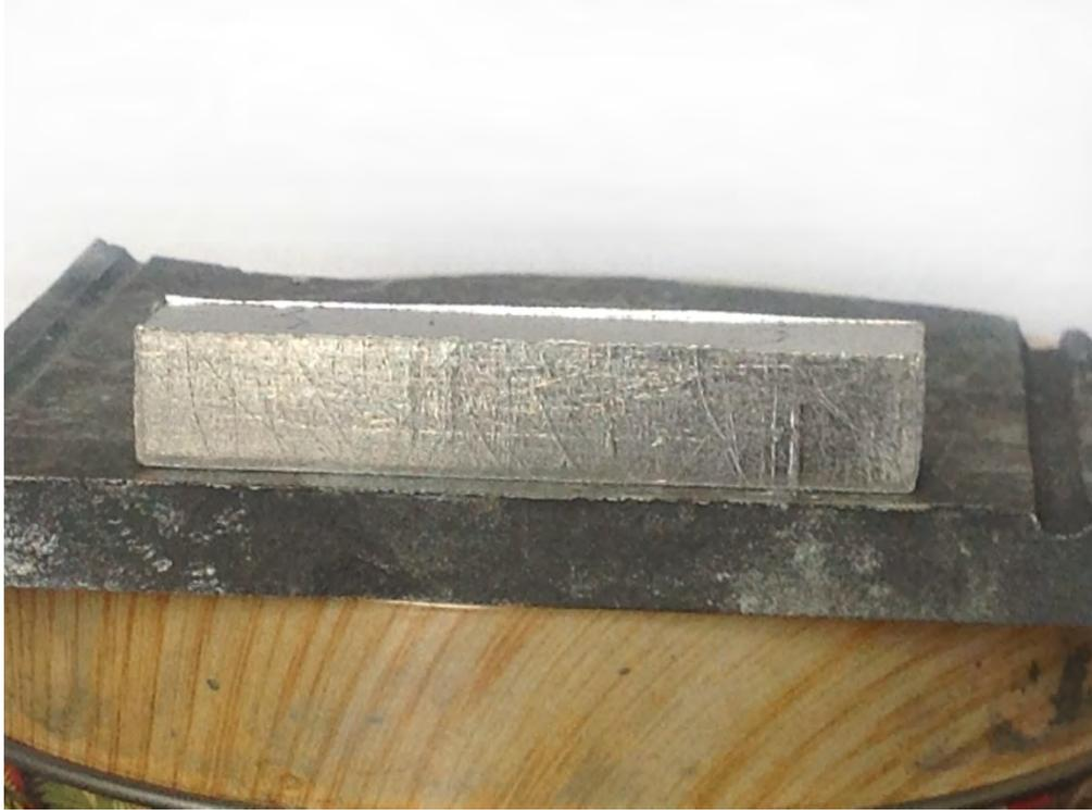
Рисунок 4.4 - Образец, полученный после отжига стеарина и последующей допрессовки
