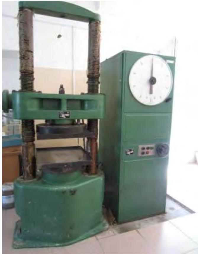
Рисунок 2.3 Гидравлический пресс П-50
