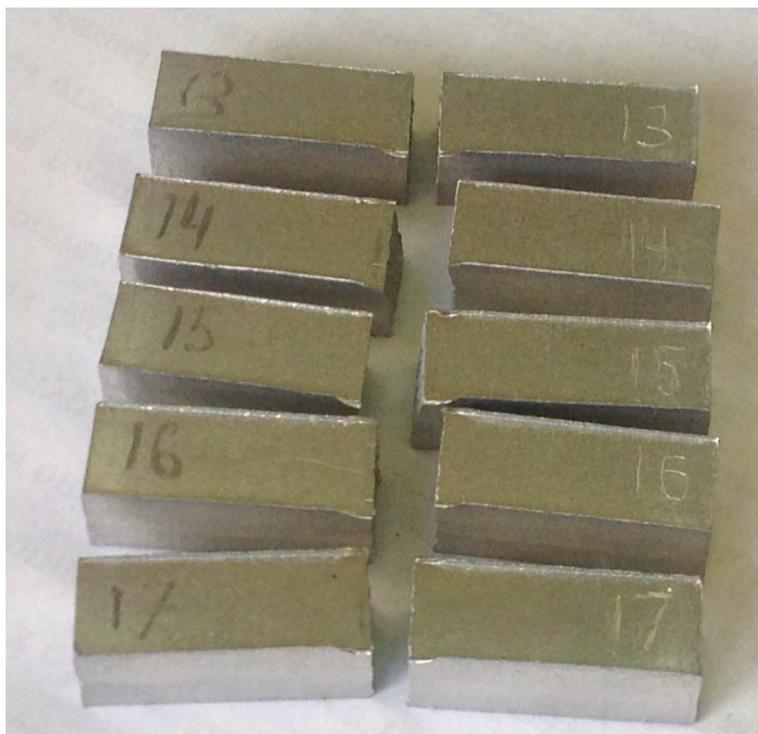
Рисунок 4.7 - Вид образцов, после проведения испытания на предел прочности при 3-х точечном изгибе. Разрушение – «куски»
