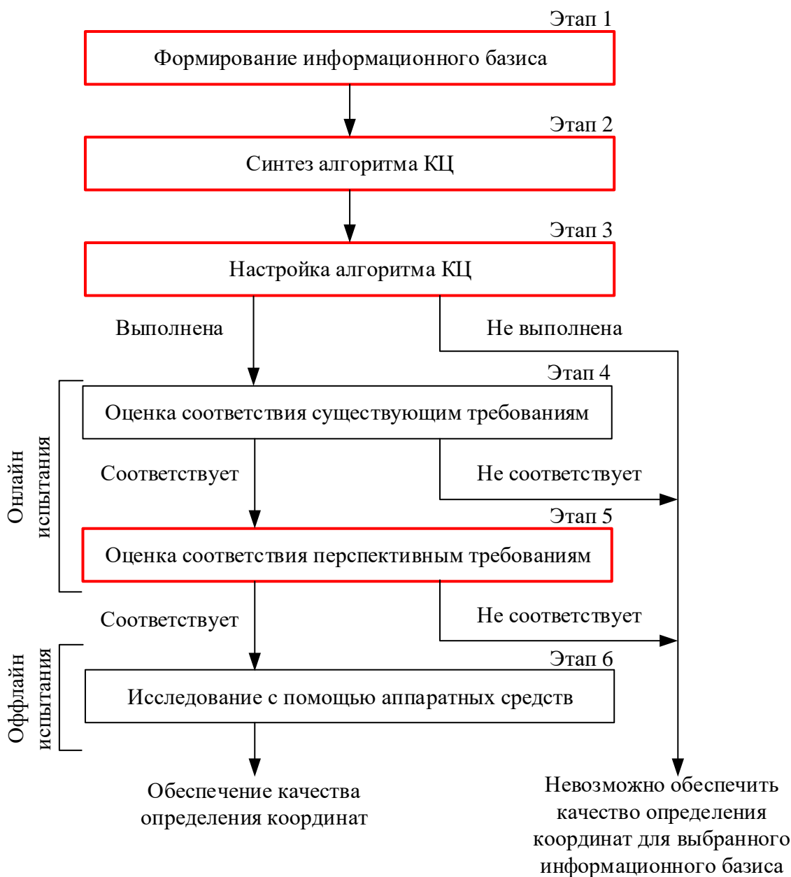
Рисунок 2 — Структура ИИС для БЛА при реализации ГАМ
