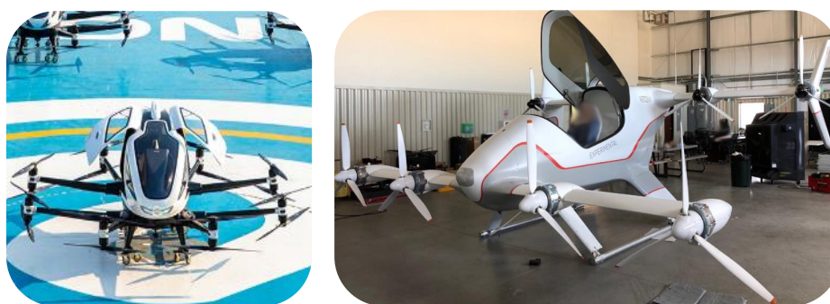
Рисунок 4 — Примеры разработанных БЛА-ВВП. Слева EHang 216, справа демонстратор технологий Airbus Vahana Alpha Two.
