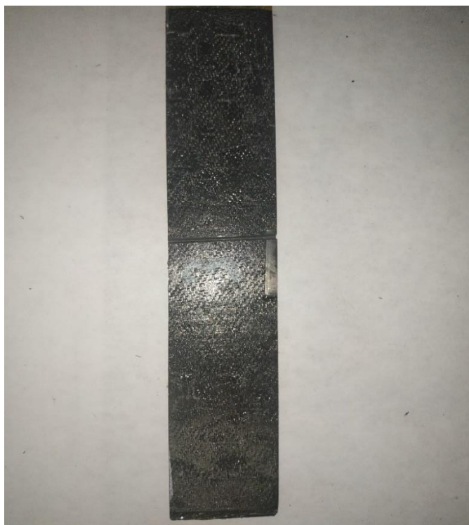
Рисунок 3.7 - Образец для испытаний на G_{IIc} .
