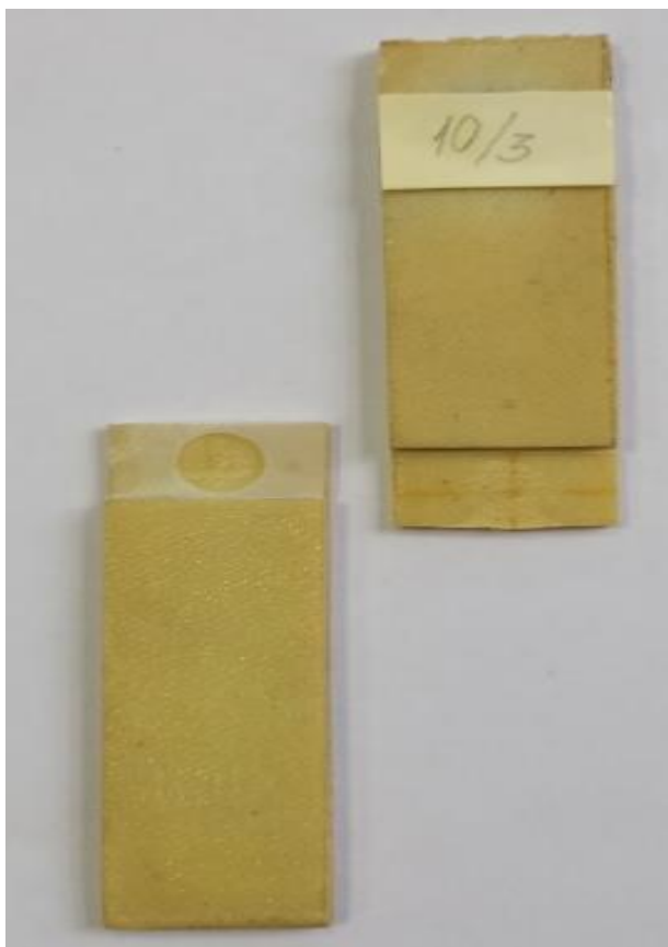
Рисунок 3.11 - Фотография поверхности образца КМКС поверхностей после испытания на когезионную прочность.
