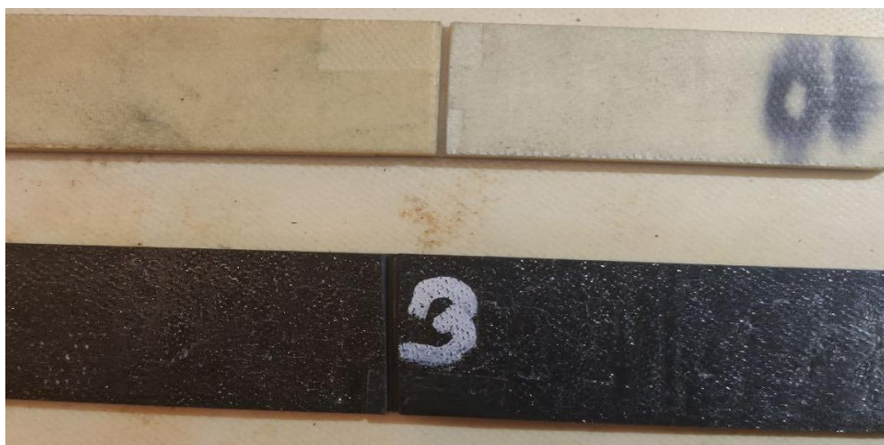
Рисунок 2.5 - Конфигурация образца ПКМ с межслоевым контактом для испытания на локальный сдвиг: F - прикладываемая нагрузка, L - длина образца, 2h - толщина образца, b - ширина образца, d - диаметр контактной зоны (а), фотографии образца УК и СК (б).
