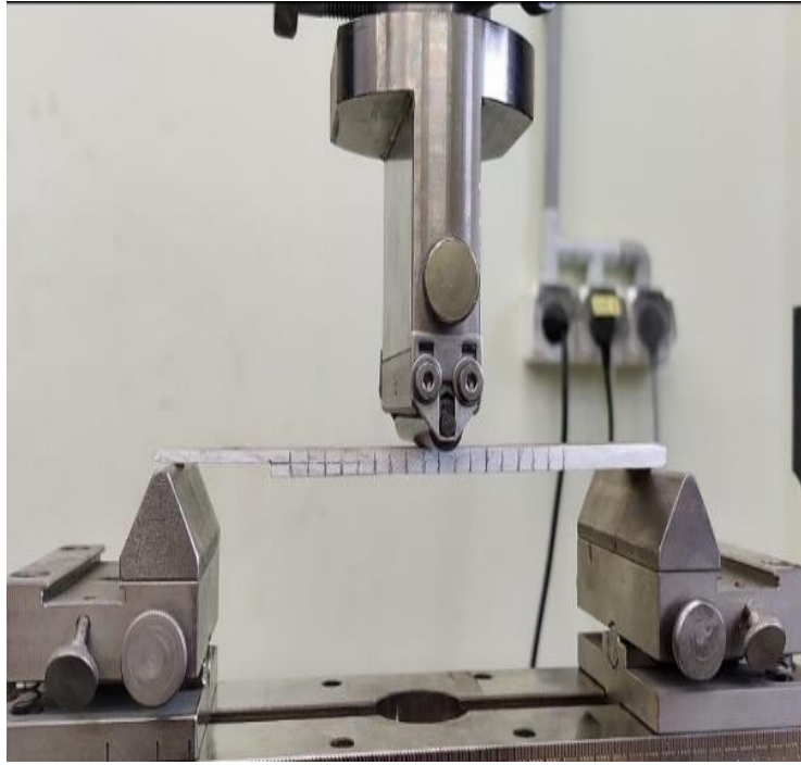
Рисунок 3.14 - Образец для определения трещиноводвижущих сил при комбинированной моде нагружения методом SLB в процессе испытания.
