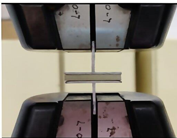
Рисунок 3.3 - Образец для определения \sigma_{IC} в процессе испытания.
