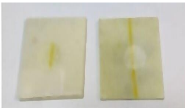
Рисунок 3.4 - Фотография поверхности образца КМКС поверхностей после испытания на когезионную прочность.
