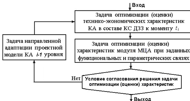
Рис. 5. Блок-схема алгоритма двухуровневого согласованного оптимизационного поиска характеристик МЦА и КА к моменту t_i
