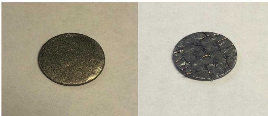
Рисунок 7 – Экспериментальный образец для исследования внеплоскостных температуропроводности и теплопроводности
