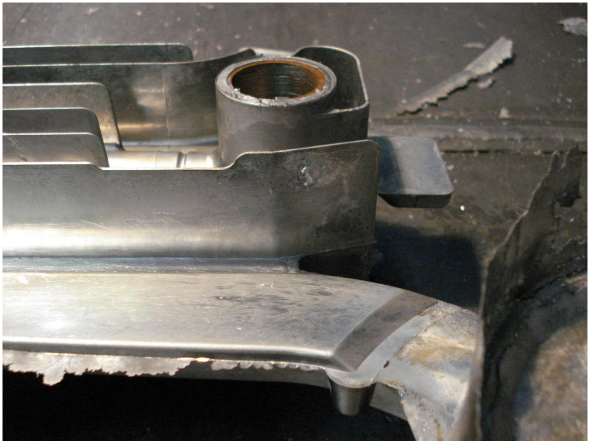
Рисунок 4.1.16 – Один неспай на ребре внизу головы
