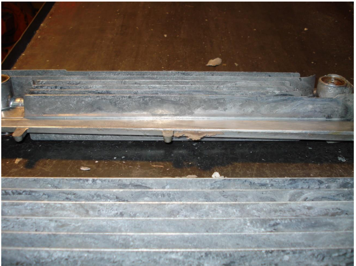
Рисунок 4.1.14 – Недоливы и пористость по всей отливке
