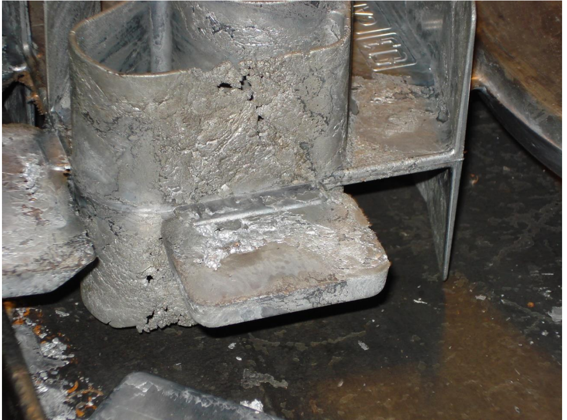
Рисунок 4.1.15 – Недоливы и пористость по нижней голове отливки
