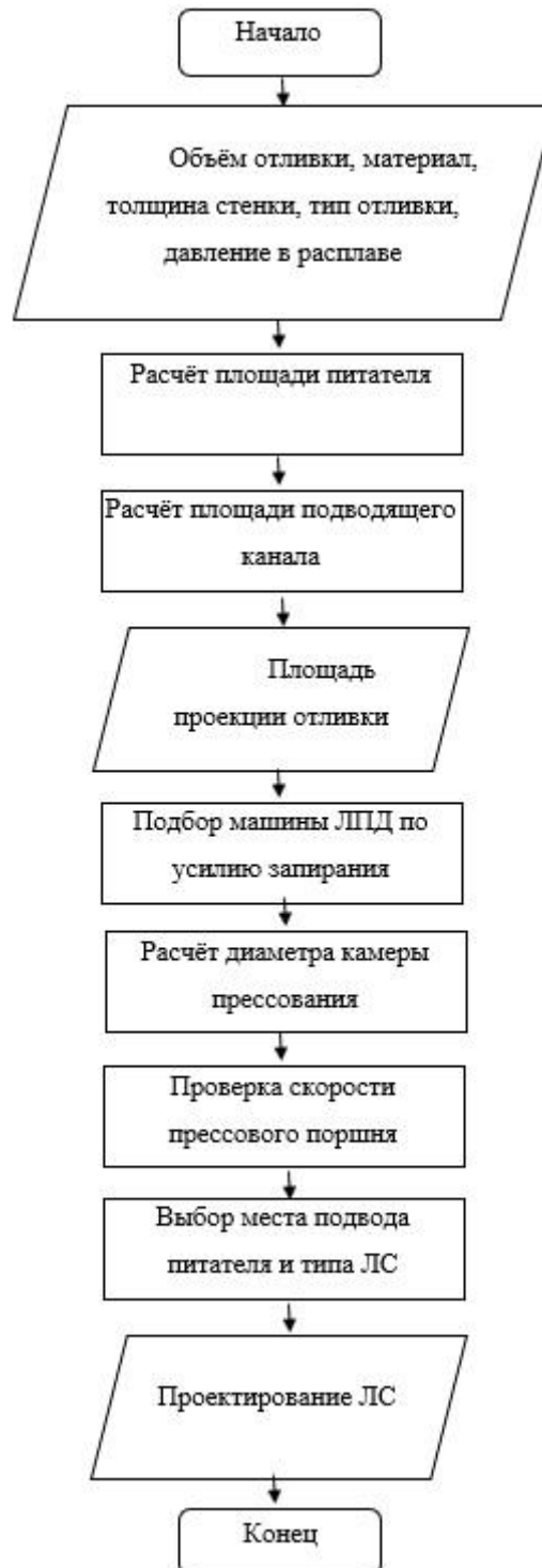
Рисунок 1.2.7 – Алгоритм расчёта литниковой системы
