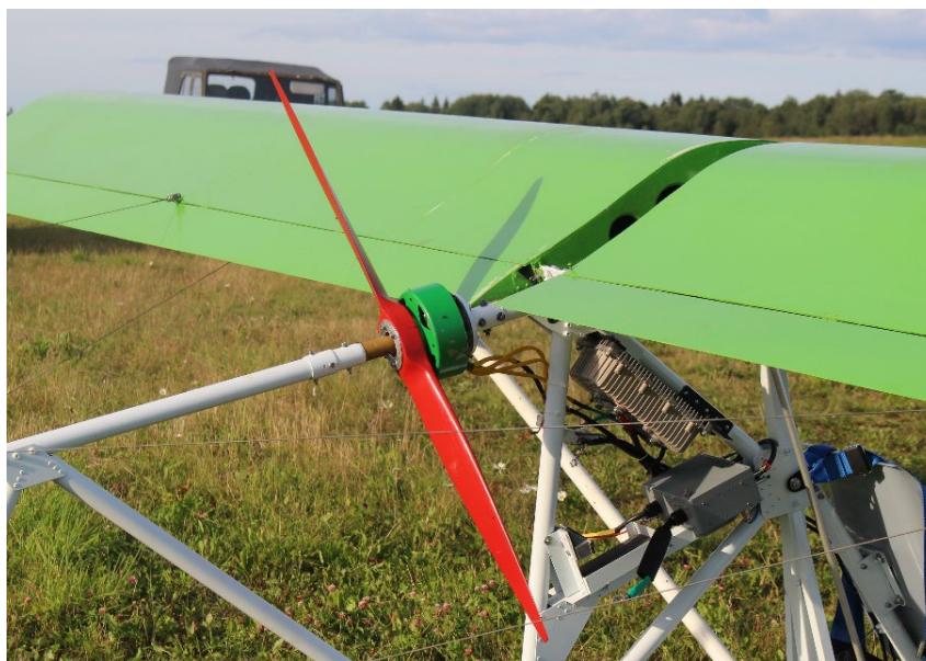
Рисунок 30. Компоновка ЭВМГ на электросамолёте
