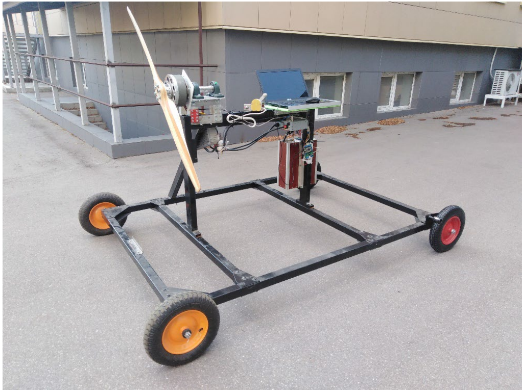
Рисунок 38. Стенд №2 для тестирования ЭСУ входящей в ГСУ
