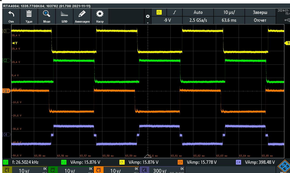
Рисунок 6.10– Осциллограмма экспериментальных исследований: желтый – входной сигнал управления драйвера; зеленый – напряжение на затворе СТК верхнего уровня; оранжевый – напряжение на затворе СТК нижнего уровня; фиолетовый – напряжение на первичной обмотке силового трансформатора мостового преобразователя.
