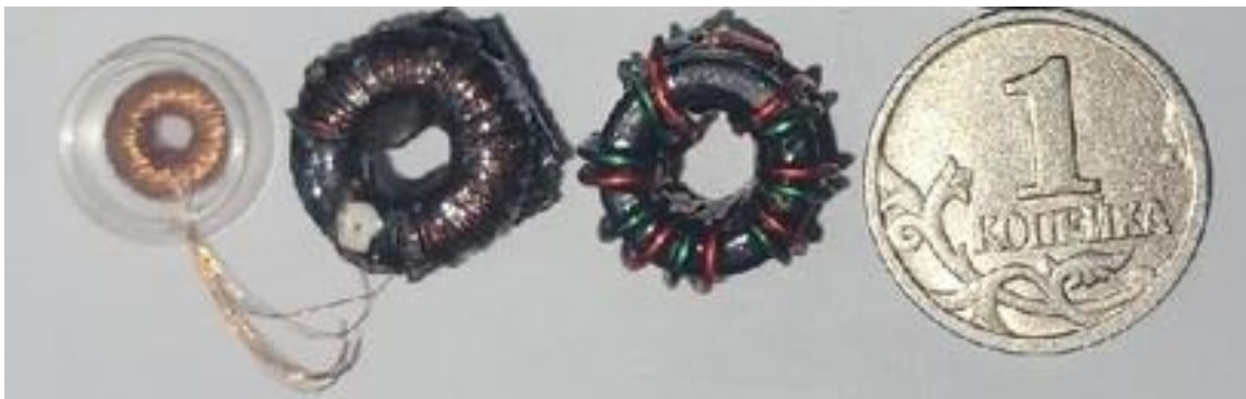
Рисунок 6.6 – Фотография трансформаторов, используемых в качестве ТГР для драйверов.
