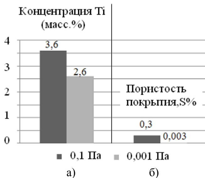
Рисунок 4 - Влияние давления аргона на содержание Ti в поверхностном слое стали 30ХГСА (а) и сплошность покрытия (б).
