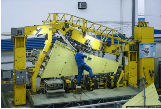
Рисунок 1.10 – Выполнение заклепочных операций в труднодоступных местах при ремонте ЛА
