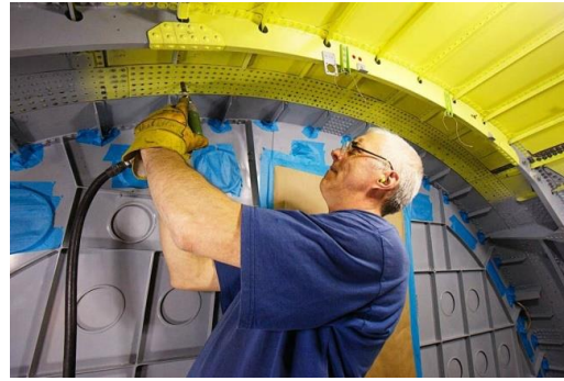
Рисунок 1.10 – Выполнение заклепочных операций в труднодоступных местах при ремонте ЛА
