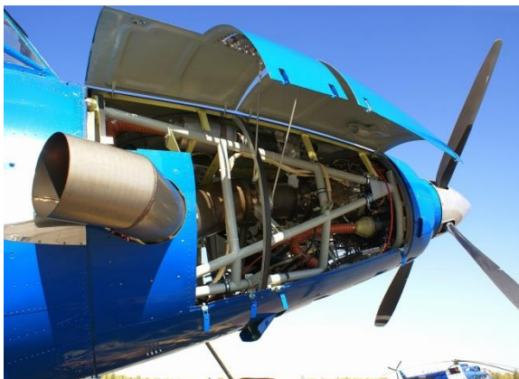
Рисунок 3.30 – Самолет ТВС-2ДТС «Байкал» ( а ) и его моторный отсек ( б )
