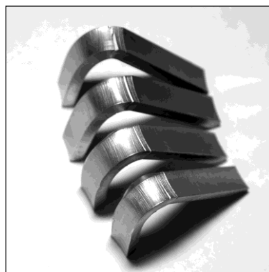
Рисунок 16 - Испытания сварных соединений на статический изгиб
